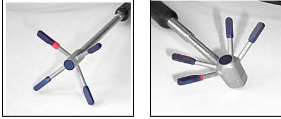
Şekil 6.21 ADV (a) Aşağı yönlü ve (b) Yanal prob.
