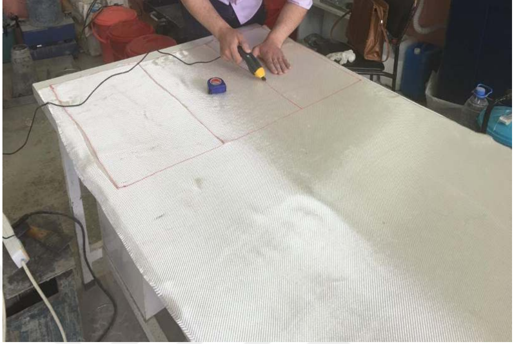
Şekil 4.11. Cam Fiber Kumaşın Kesilip Hazırlanması
