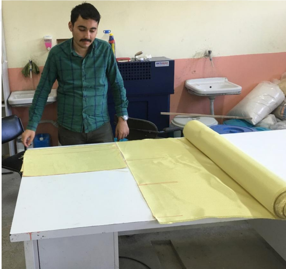
Şekil 4.12. Aramid Fiber Kumaşın Kesilip Hazırlanması
