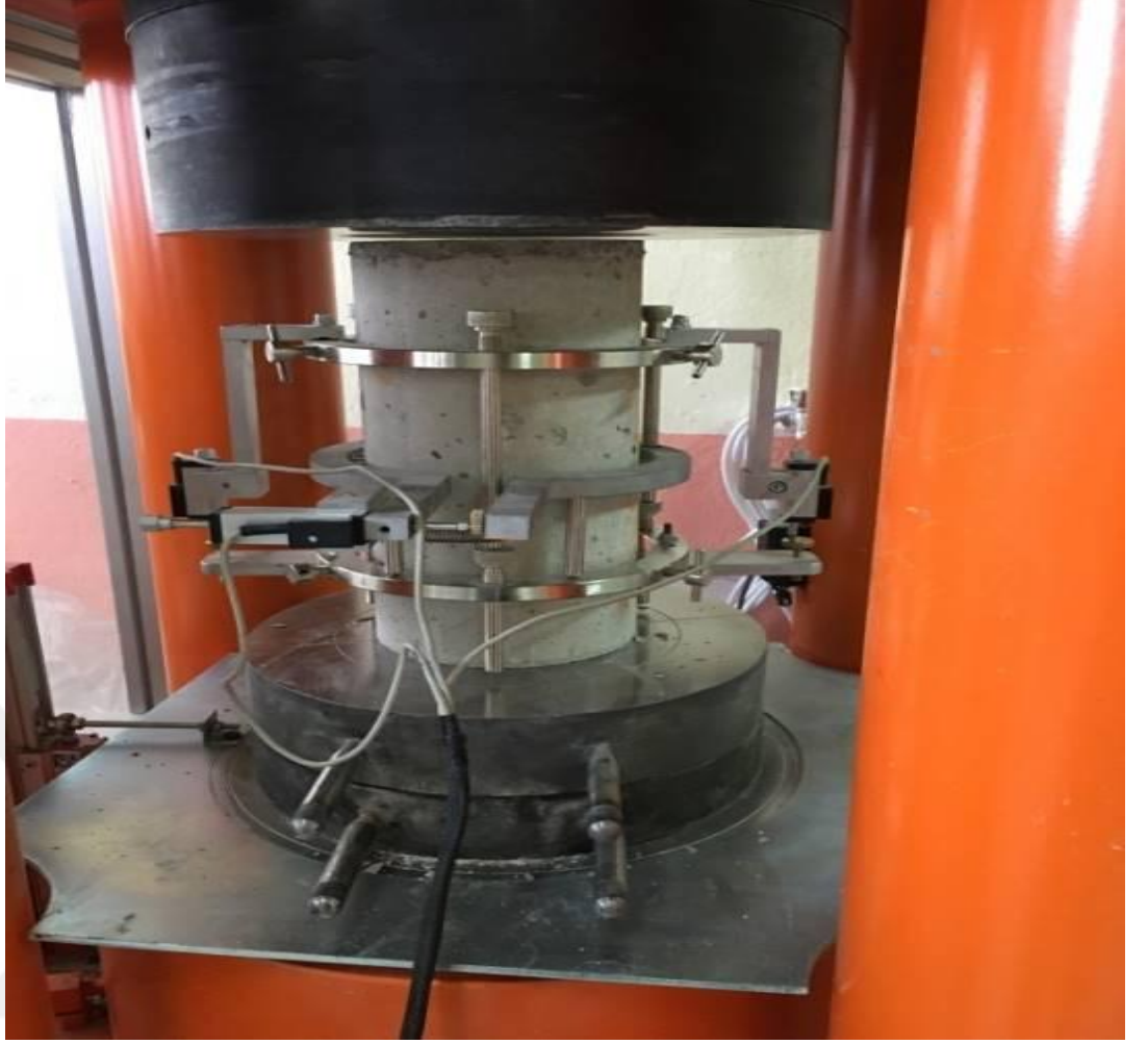
Şekil 4.18. Eksantrometre Yerleştirilen Numune
