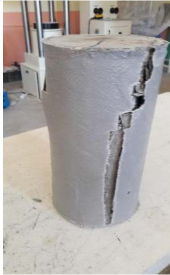
Şekil 5.13. Basınç Deneyinde Kırılmış GFRP Sargılı Beton Numune
