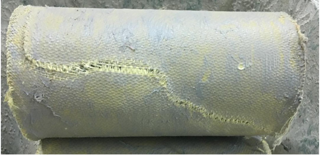
Şekil 5.32. Basınç Deneyinde Kırılmış AFRP Sargılı Beton Numune
