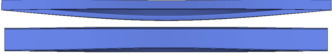
Şekil 3.10. 6 m uzunluğundaki basit kirişte yanal desteğin kesit merkezinde olduğu durumda \beta_y = 1000 \text{ kN/m} için yanal burkulmuş hali (üstten ve önden)
