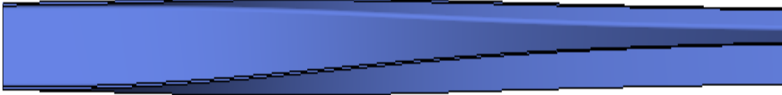
Şekil 3.22. 6 m uzunluğundaki konsol kirişin \beta_y = 1000 \text{ kN/m} için yanal burkulmuş hali
