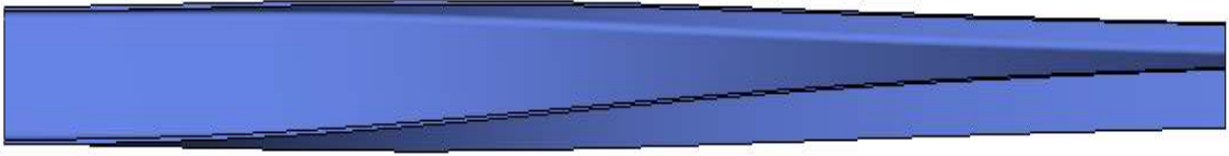
Şekil 3.21. 6 m uzunluğundaki konsol kirişin \beta_y = 500 \text{ kN/m} için yanal burkulmuş hali
