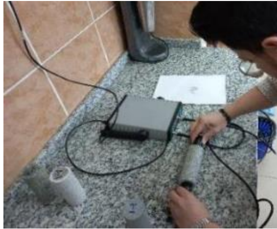
Şekil 14. Silindirik numunelerin P dalga hızlarını ölçmek için kullanılan ultrasonik hız test cihazı
