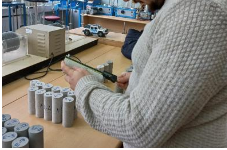
Şekil 10. Silindirik numunelerin çap ve boylarının kumpas aracılığıyla ölçülmesi
