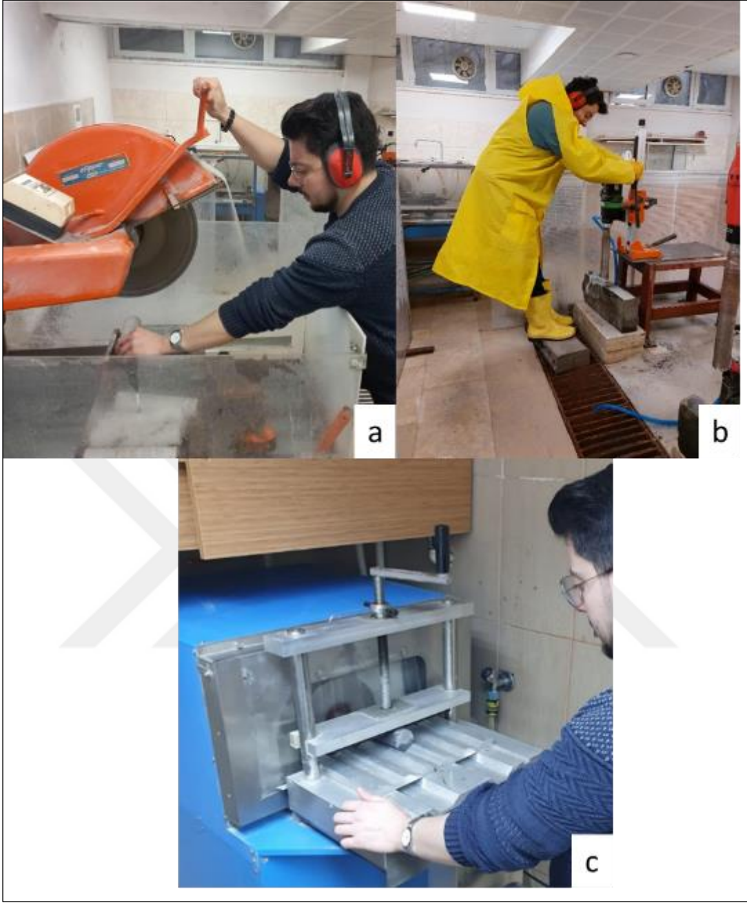
Şekil 8. Silindirik karot uçlarının kesilmesi (a), Blok örneklerden silindirik karot çıkarma işlemi (b), Karot uçlarının düzeltilmesinde kullanılan karot ucu düzeltme cihazı (c)
