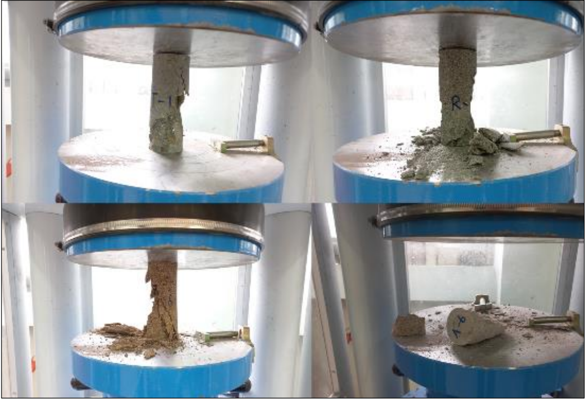
Şekil 13. Tek eksenli basınç deneyi
