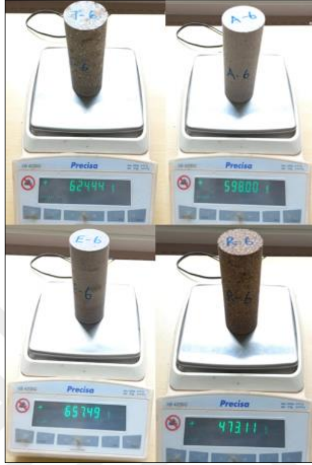
Şekil 11. Numunelerin kuru kütlelerinin belirlenmesi
