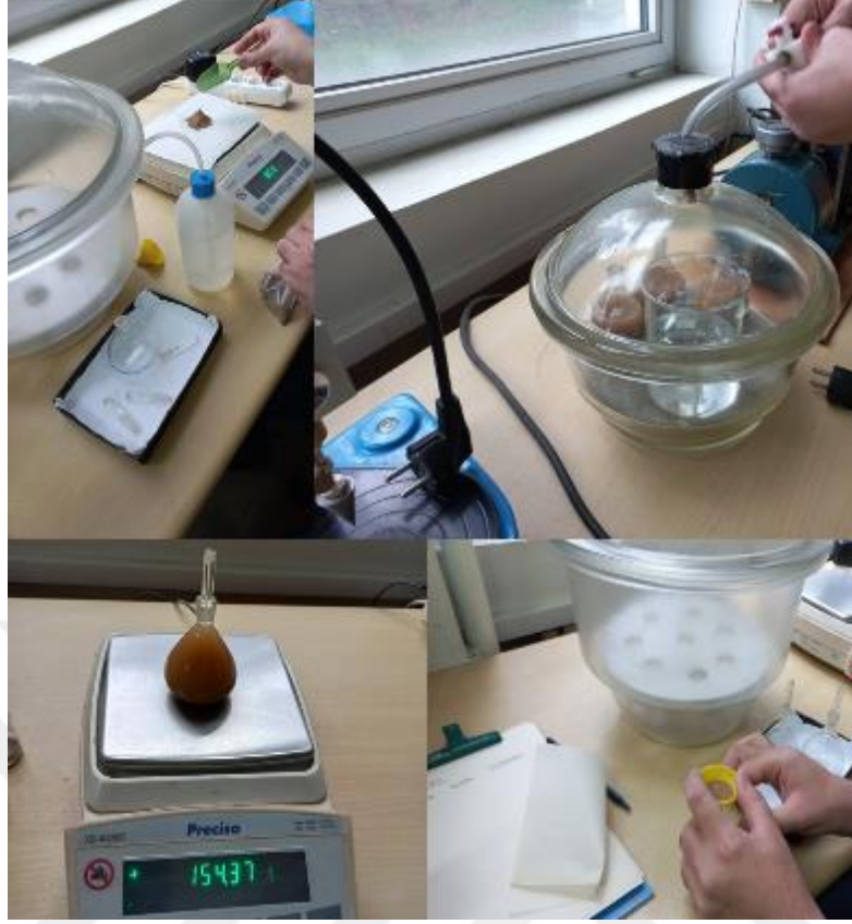
Şekil 12. Vakum pompası, desikatör, hassas terazi ve piknometre ile özgül ağırlık tayini deneyinin yapılışı
