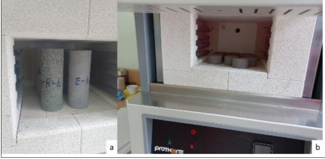
Şekil 18. Isıl işlem görmüş silindirik numuneler (a), Dolaylı çekme dayanımı için ısıl işlem görmüş numuneler (b)
