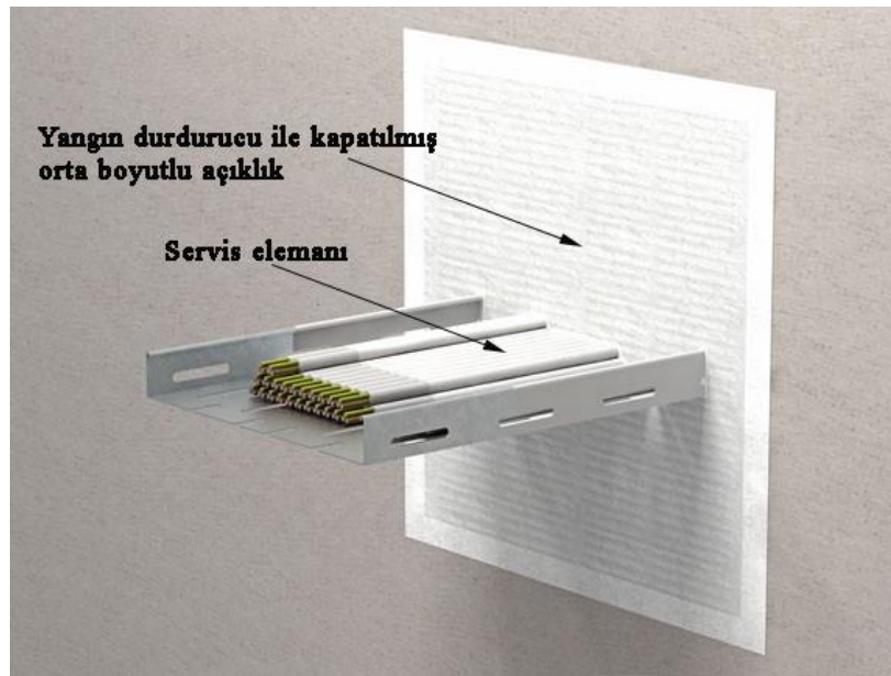
Şekil 3.7: Orta boyutlu açıklıklardan servis geçişi örneği [16].
