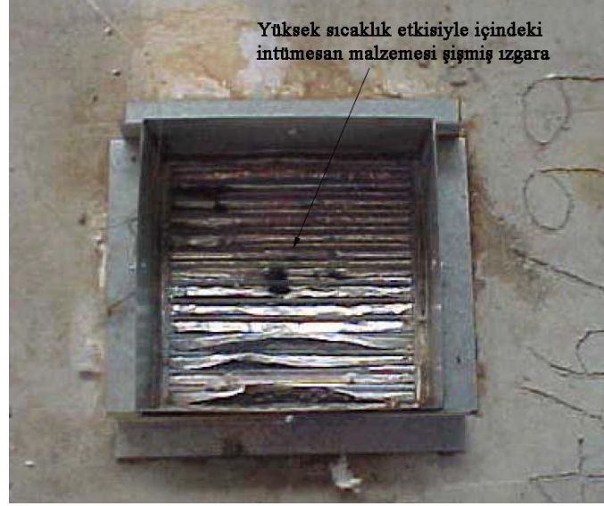
Şekil 4.51: Yüksek sıcaklıkla şişmiş damper ızgara sistemi [17].
