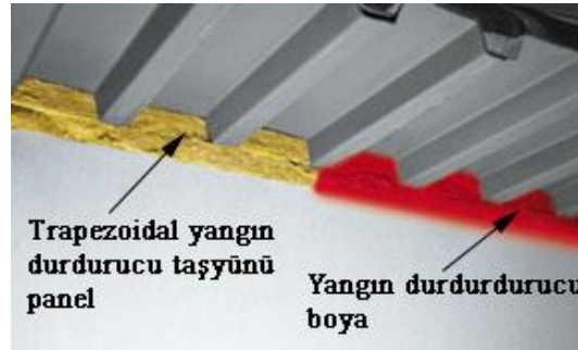
Şekil 4.49: Duvar başı yangın durdurucu panel uygulaması örneği [3].
