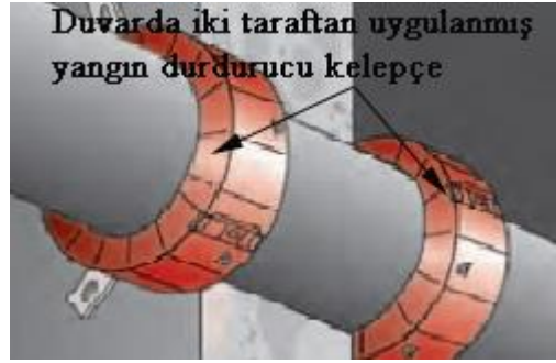
Şekil 4.19: Duvar üzerinde yangın durdurucu kelepçe uygulaması [3].
