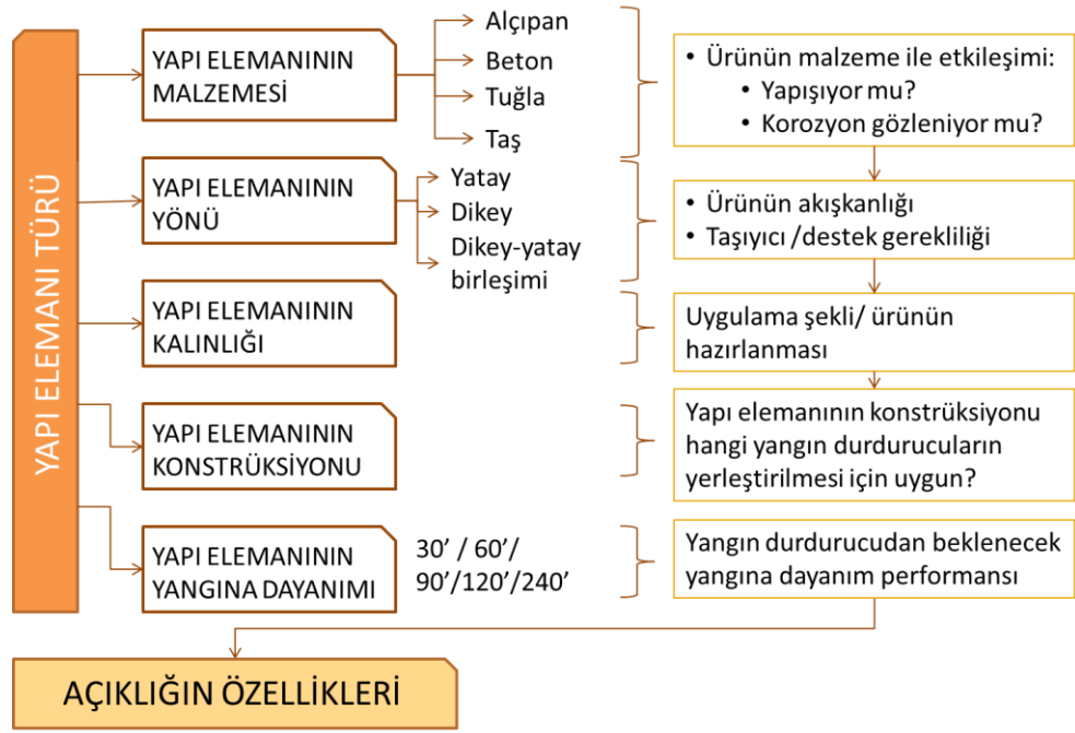
Şekil 5.4: Yapı elemanı türünün yangın durdurucu seçimine etkisi.
