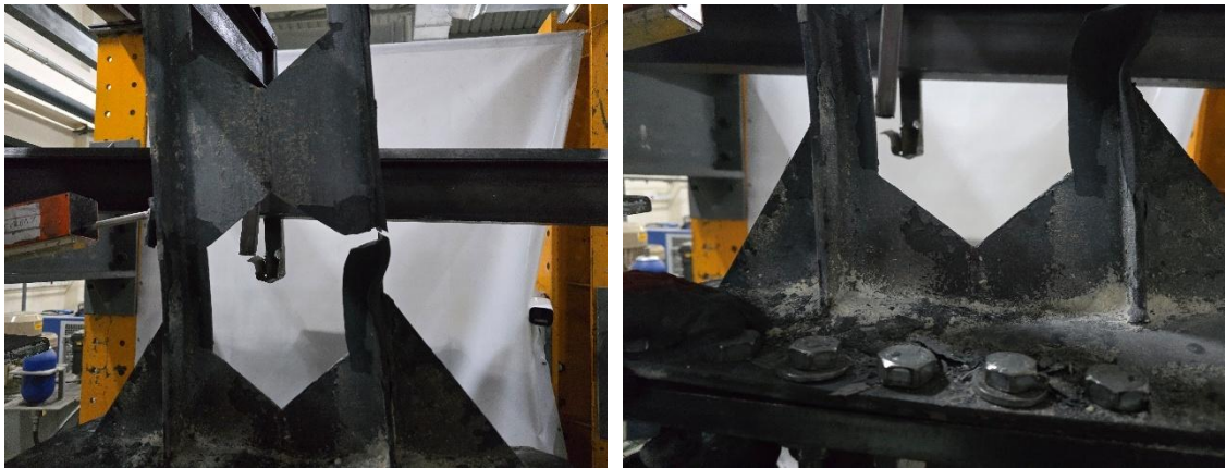
Şekil 17. IPE 140-P-BK-Y numunesine ait göçme modu davranışı
