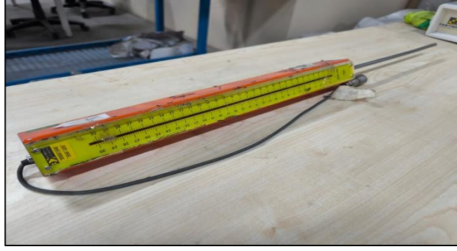
Şekil 8. Deformasyon ölçme cihazı (LVDT)
