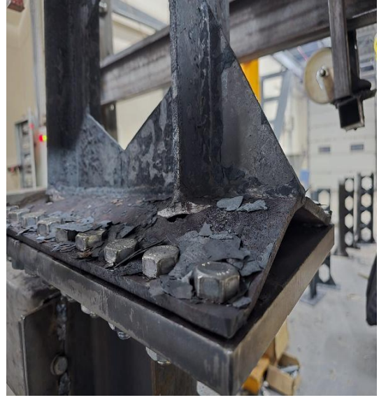
Şekil 35. IPE 200-P-B-Y numunesine ait göçme modu davranışı
