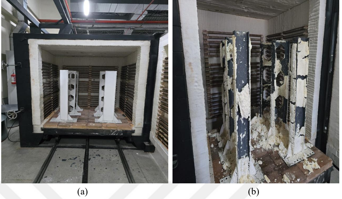
Şekil 6. (a) Yangın deneyi öncesi boya korumalı numuneler (b) Yangın deneyi sonrası boya korumalı numuneler
