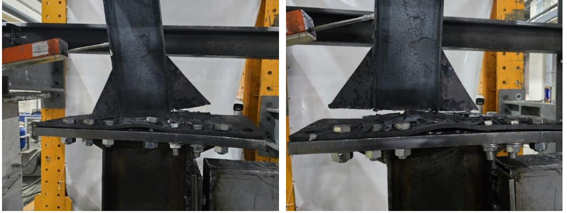
Şekil 33. IPE 140-Y numunesine ait göçme modu davranışı
