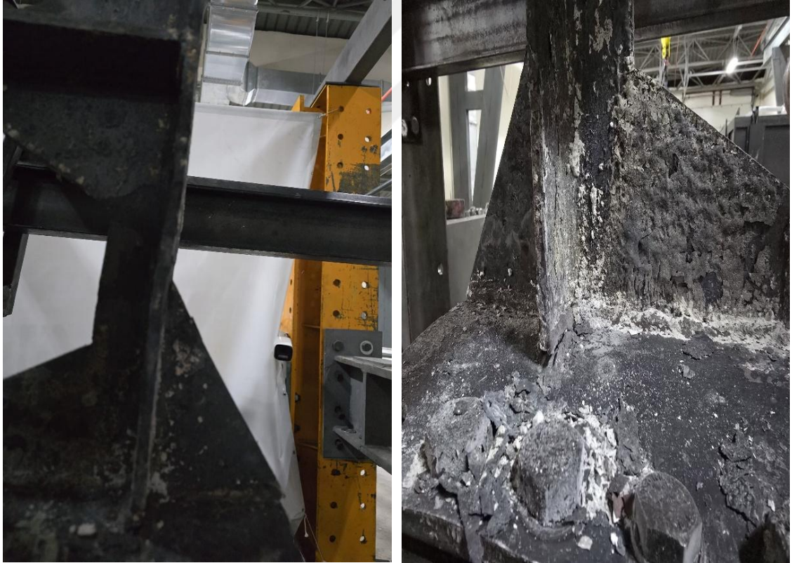
Şekil 23. IPE 200-P-B-BK-Y numunesine ait göçme modu davranışı
