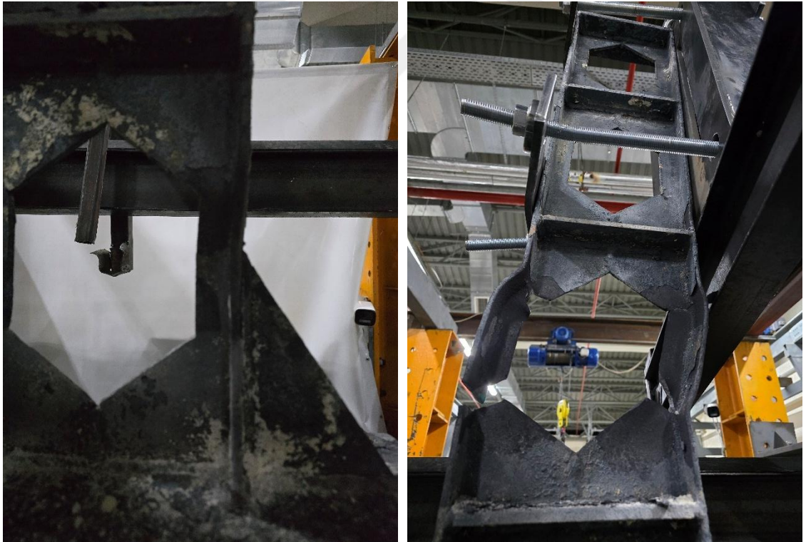
Şekil 19. IPE 140-P-B-BK-Y numunesine ait göçme modu davranışı
