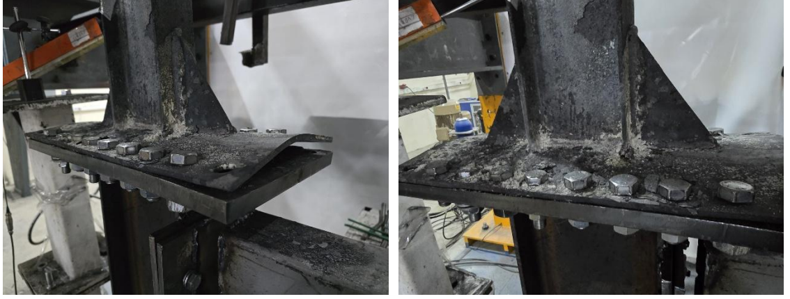
Şekil 25. IPE 140-BK-Y numunesine ait göçme modu davranışı
