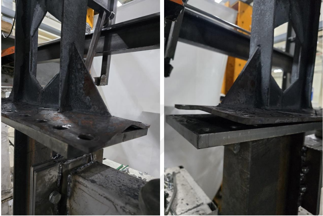
Şekil 29. IPE 140-P-Y numunesine ait göçme modu davranışı
