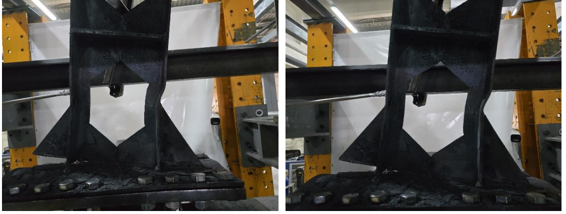
Şekil 31. IPE 140-P-B-Y numunesine ait göçme modu davranışı
