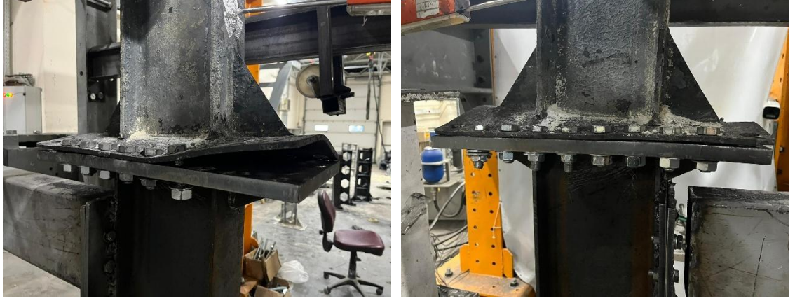
Şekil 27. IPE 200-BK-Y numunesine ait göçme modu davranışı
