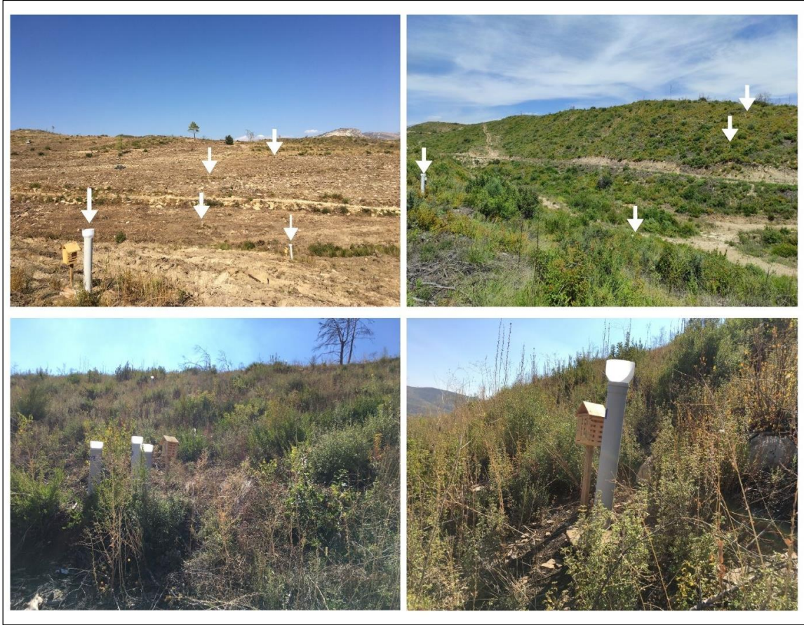
Fotoğraf 2.17 Havzalara Yerleştirilen Yağmur Suyu Örnekleyici Kaplardan Bir Görünüm
