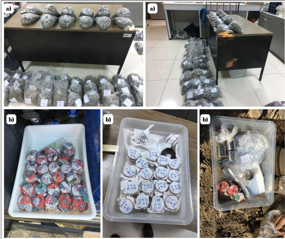
Fotoğraf 2.13 Doğal Yapısı Bozulmuş (a) ve Doğal Yapısı Bozulmamış (b) Toprak Örneklerine Ait Görseller
