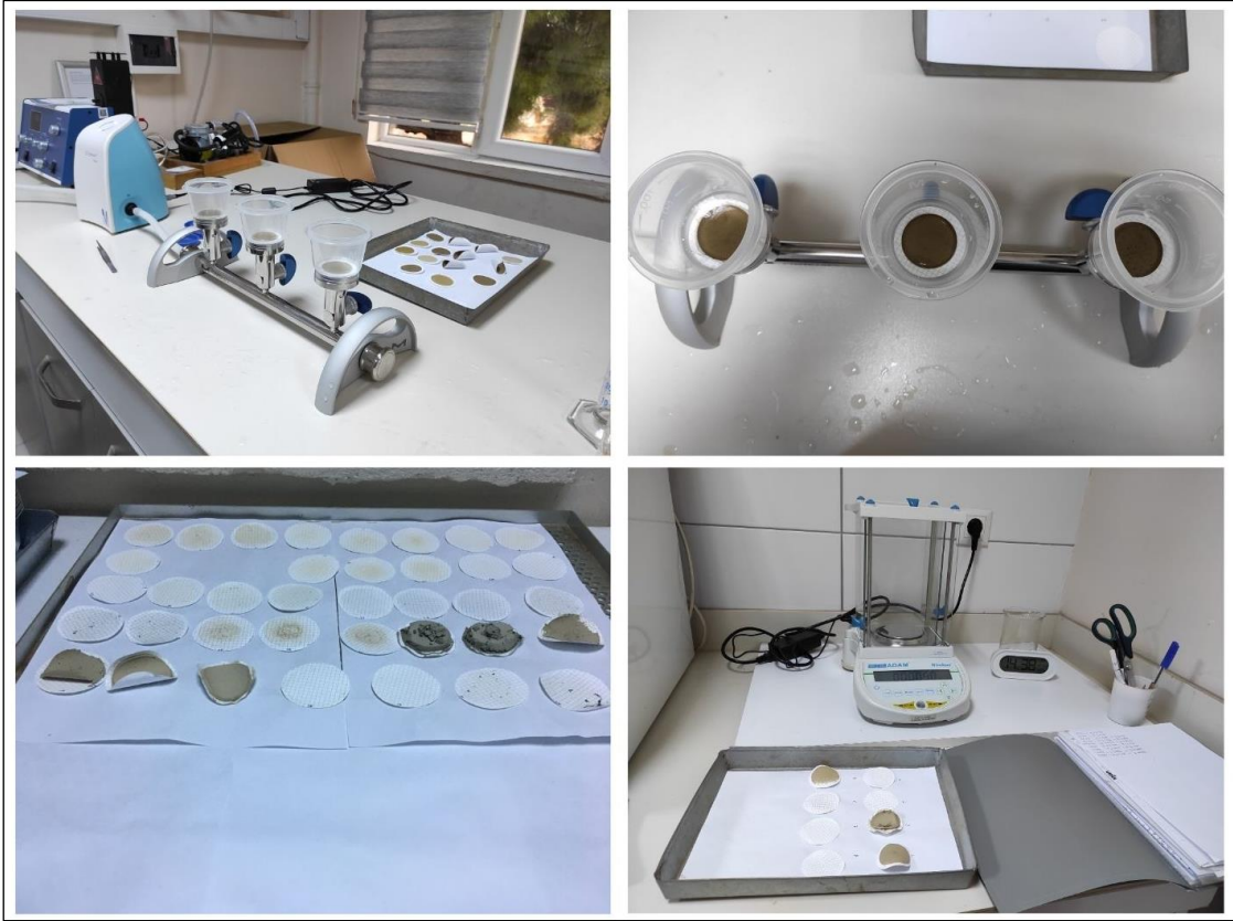
Fotoğraf 2.23 Yüzeysel Akış Örneklerinde Süspanse Sediman Konsantrasyonun Belirlenmesi Aşamasından (Filtrasyon, Kurutma ve Tartma) Bir Görünüm
