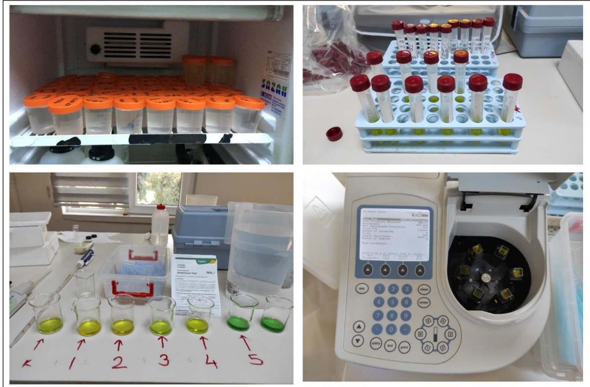
Fotoğraf 2.22 Yüzeysel Akış Örneklerinin Saklanma Koşullarından ve Spektrofotometrik Analiz Aşamasından Bir Görünüm
