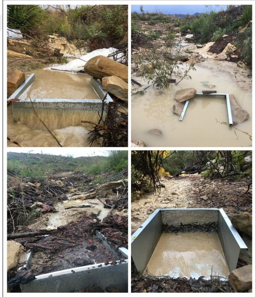
Fotoğraf 2.24 Akarsu Yatağının Yüzeyine Yerleştirilen Sediman Tuzaklarından Bir Görünüm
