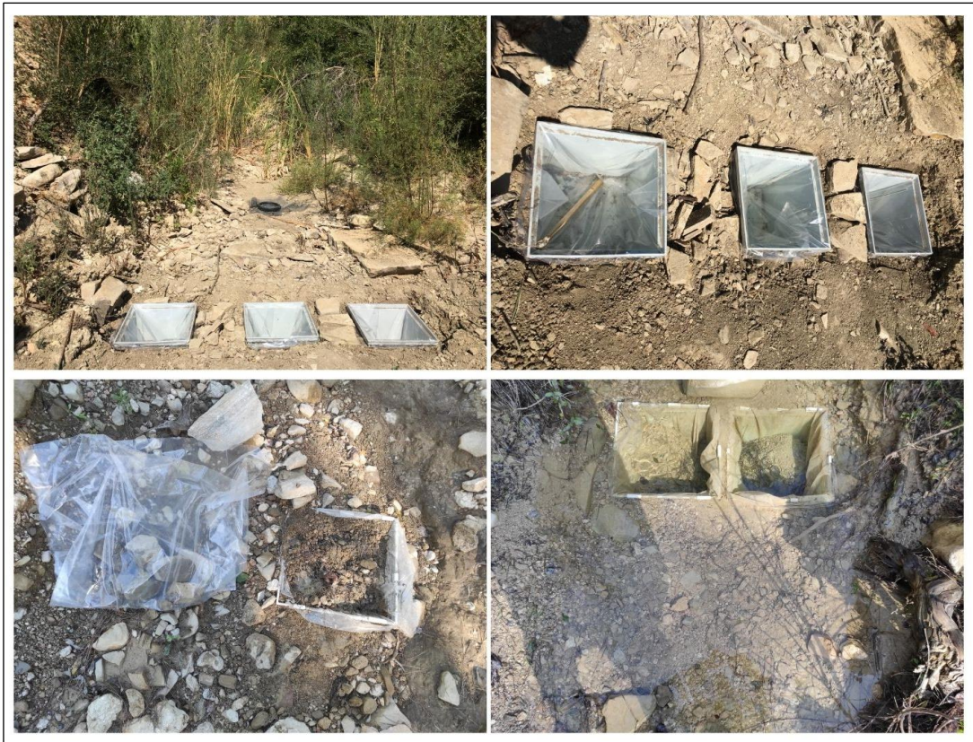
Fotoğraf 2.25 Akarsu Yatağına Gömülü Olarak Yerleştirilen Sediman Tuzaklarından Bir Görünüm
