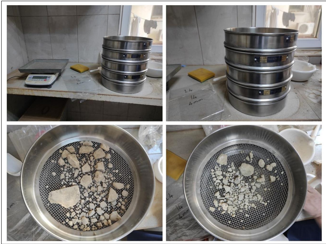
Fotoğraf 2.27 Alınan Sediman Örneklerinin Tane Boyutu Analizi Aşamasından Bir Görünüm
