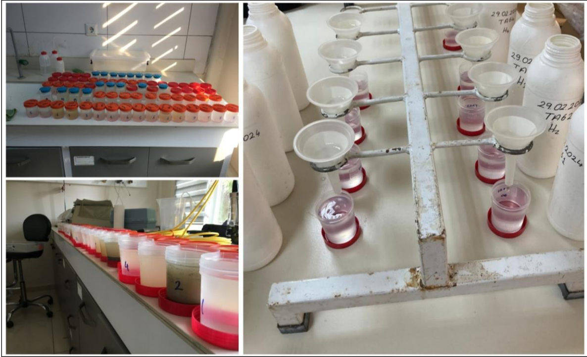
Fotoğraf 2.21 Yüzeysel Akış Örneklerinin Süzülmesi (Filtrasyon) Aşamasından Bir Görünüm
