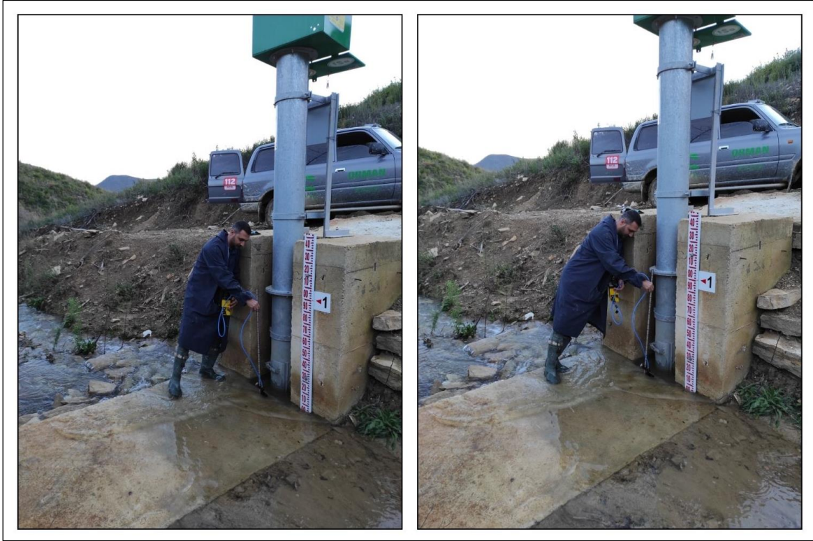
Fotoğraf 2. 20 Yağış Olayının Ardından Elektromanyetik Muline ile Su Hızı Ölçümünden Bir Görünüm
