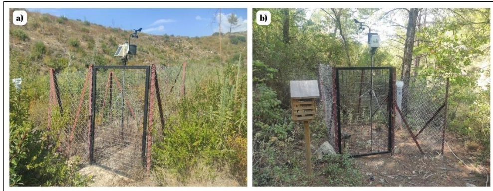
Fotoğraf 2.18 Doğal Haline Bırakılan Havzaya (a) ve Kontrol Sahasına (b) Kurulan Otomatik Meteoroloji İstasyonundan Bir Görünüm
