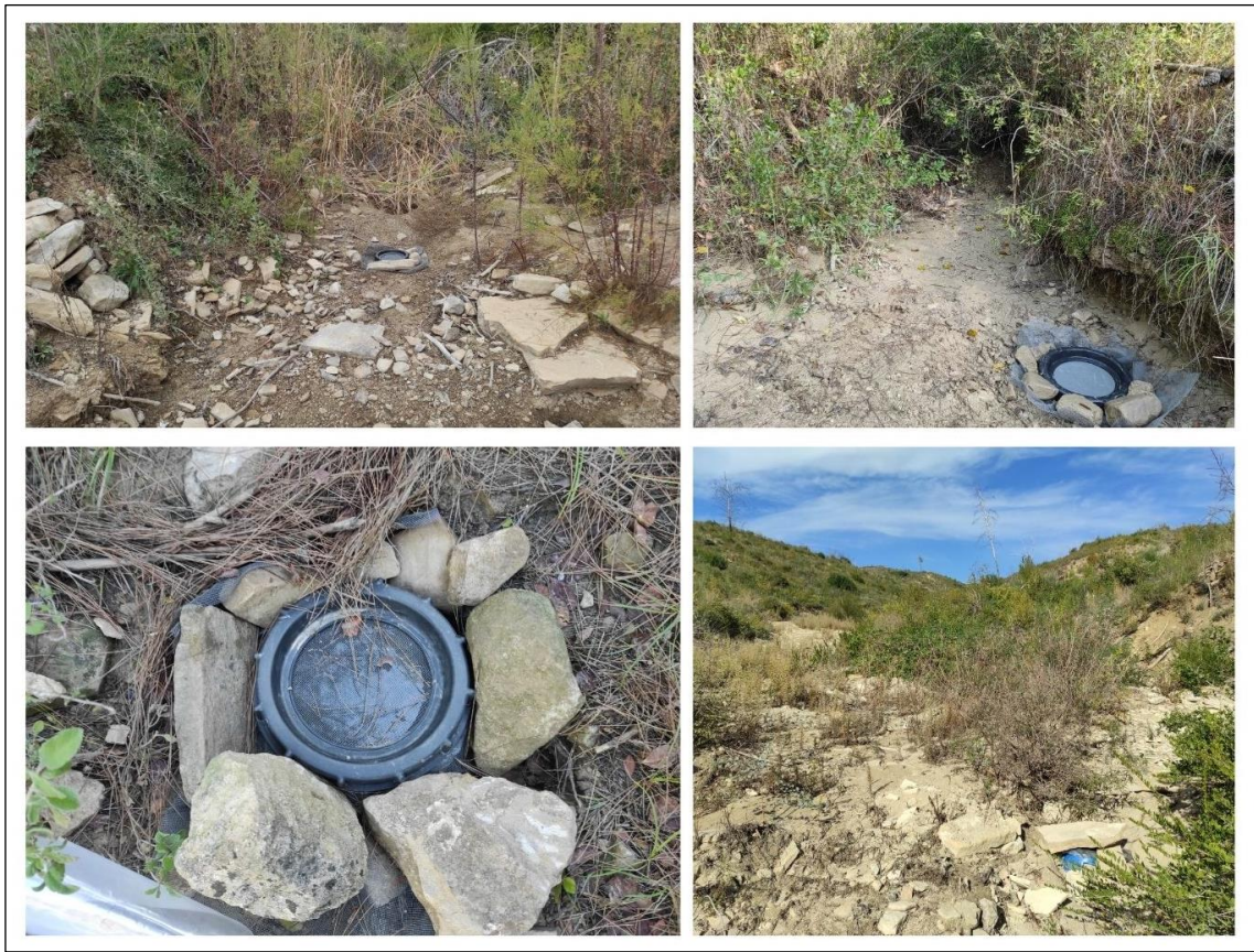
Fotoğraf 2.29 Akarsu Yatağına Yerleştirilen Yüzeysel Akış Örnekleme Kapları
