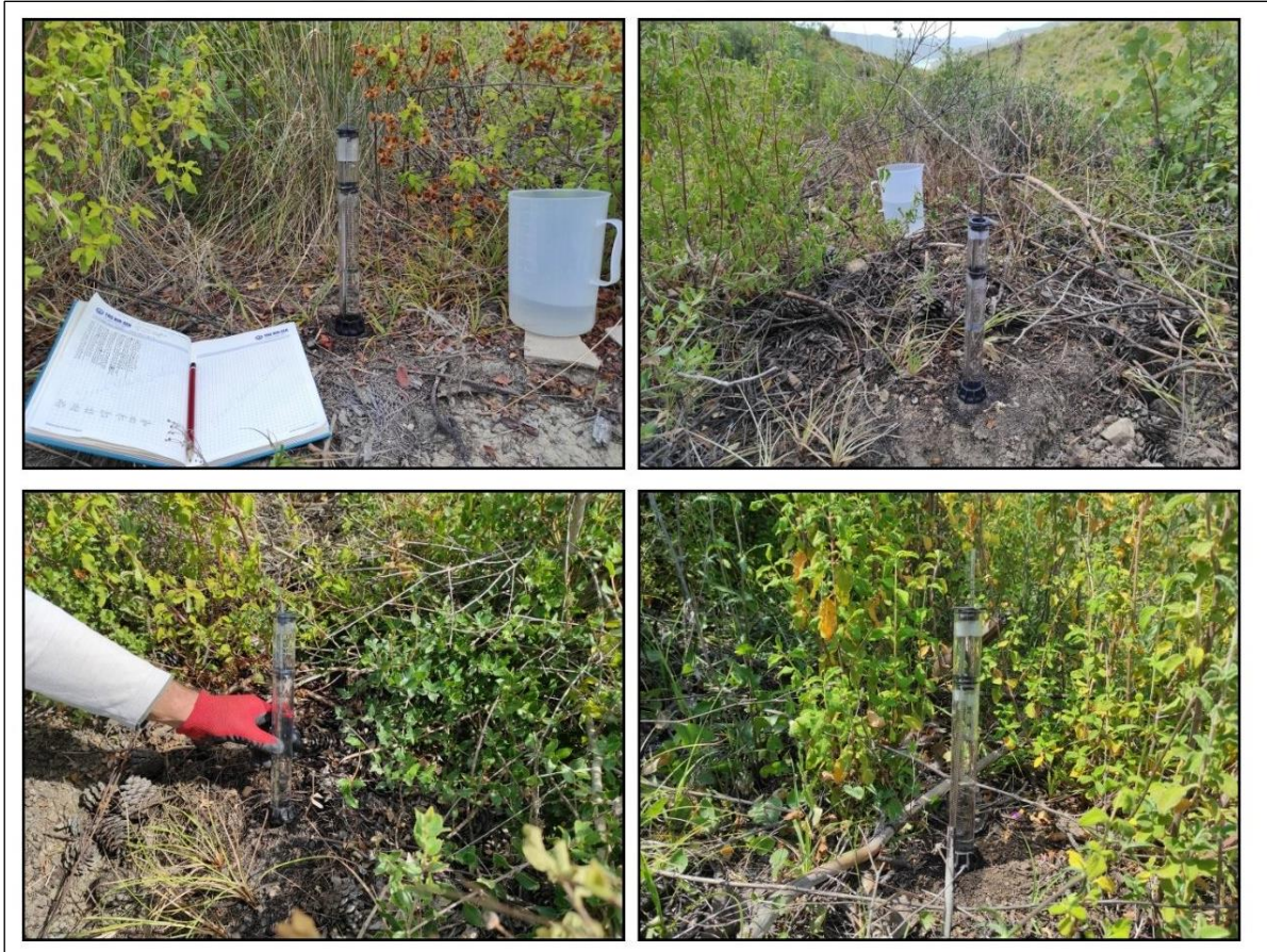
Fotoğraf 2.14 Üretim Faaliyetleri (Salvage Logging) ve Rehabilitasyon Döneminde İnfiltrasyon Hızı ve Hidrolik İletkenlik Ölçümlerinden Bir Görünüm
