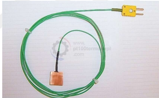
Şekil 3. 16: Termokupl (Isıl Çift-Sıcaklık Sensörü).
