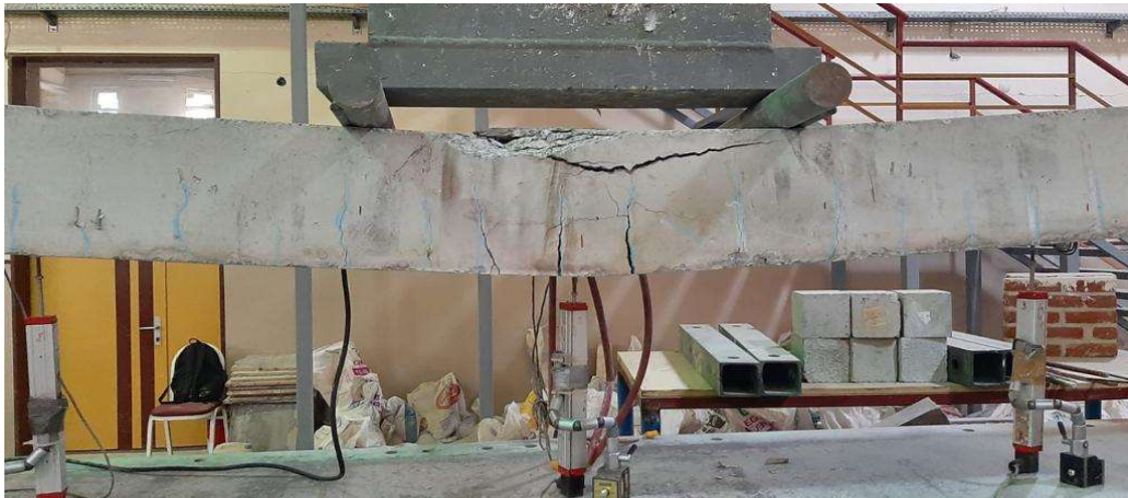
Şekil 4. 9: Deney elemanı-3 103 mm deplasman altında meydana gelen eğilme çatlakları ve beton ezilmesi
