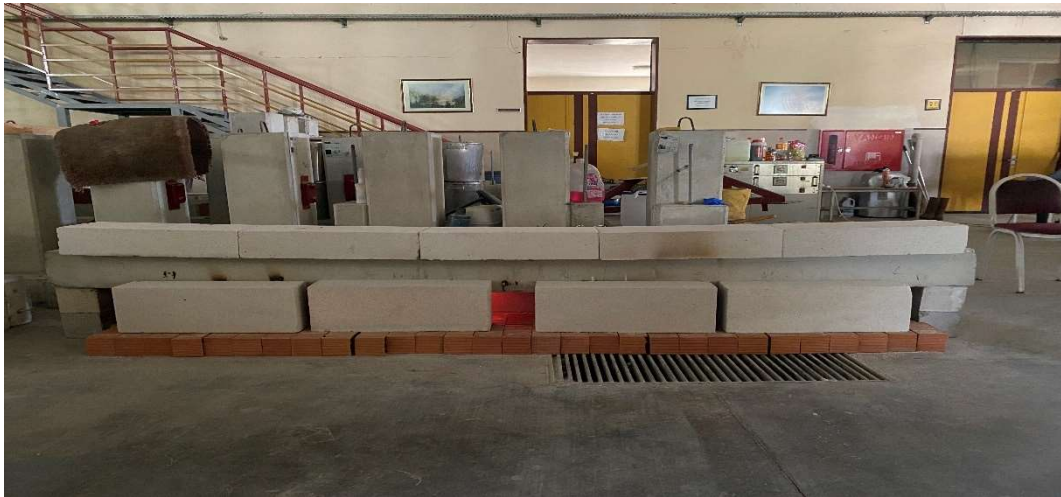
Şekil 3. 11: Numunelerin deney sonunda yerçekimi yönünde hafif eğilmesi
