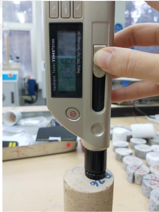
Şekil 7. Equotip sertlik cihazı
