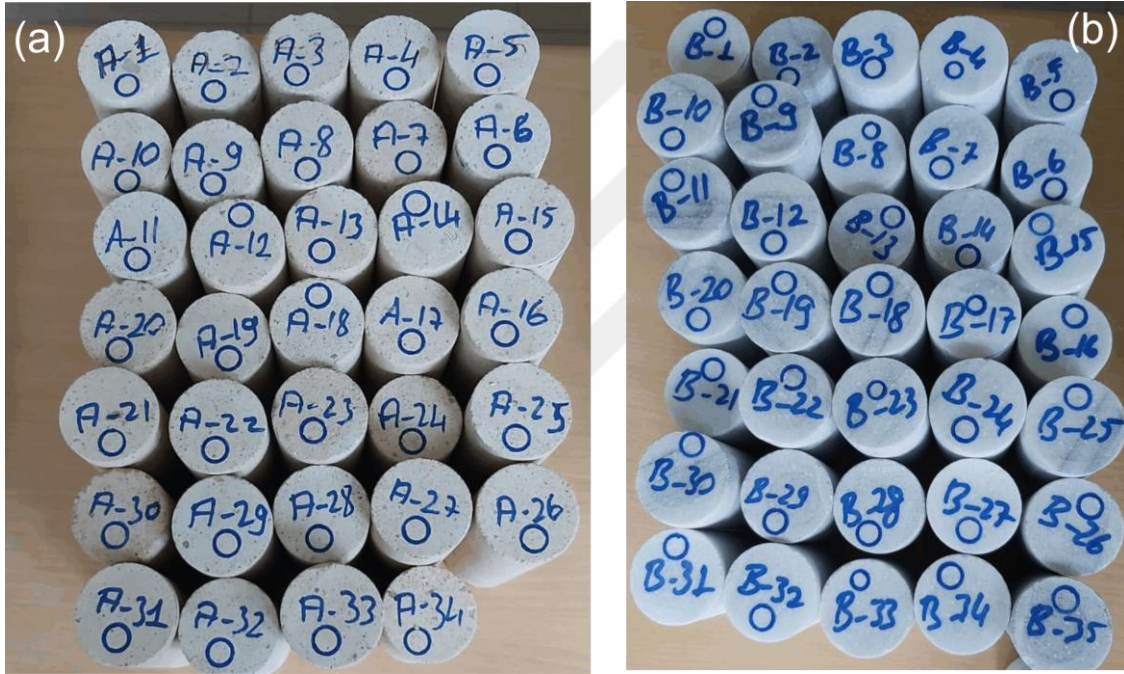
Şekil 2. Örnek resimleri (a) kireçtaşı örnekleri (b) mermer örnekleri
