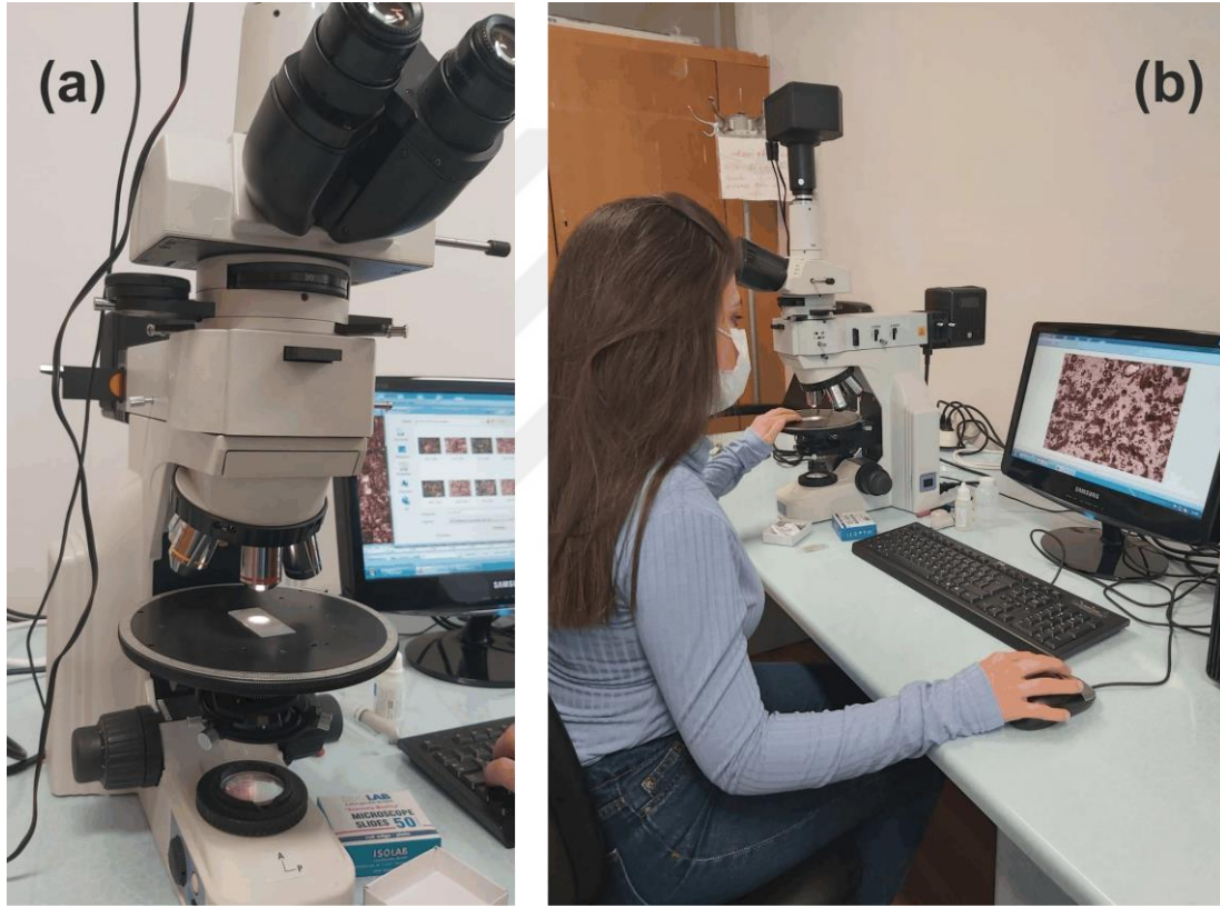
Şekil 10. (a) Polarizan mikroskop, (b) örneklerin ince kesitlerinin incelenmesi
