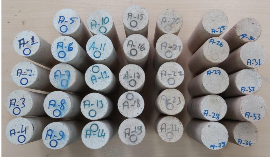
Şekil 9. Isıl işlem görmüş kireçtaşı örnekleri
