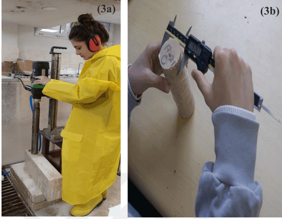
Şekil 3. (a) örnek bloklarından karot alınması işlemi , (b) örneklerin kumpas yardımı ile çap, boylarının belirlenmesi
