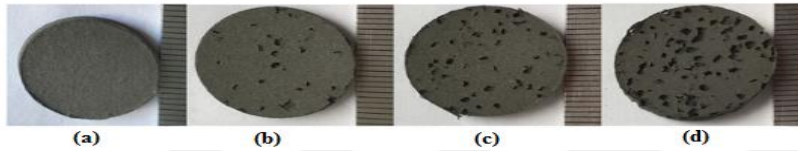
Şekil 2.11. Hacimce %0 ve %60 \text{CO}(\text{NH}_2)_2 içerikli 2 saat ve 750° C'de 30 dakika sinterlenmiş \text{TiAl}_3 parçaların makro görüntüleri (Jiao vd. 2018)
