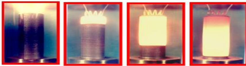
Şekil 2.3. KİYSS'de başlangıç malzemelerinin ateşlenmesi ve reaksiyon dalgasının ilerleyişi (Merzhanov 2012)
