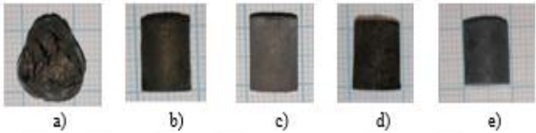
Şekil 4.7. %20, 30, 40 ve 50 termal seyreltici NiAl-H ve %60 BO üre ile üretilen parçaların görüntüleri a) 0 NiAl-H+60üre, b) 20 NiAl-H+60üre, c) 30 NiAl-H+60üre, d) 40 NiAl-H+60üre e) 50 NiAl-H+60üre
