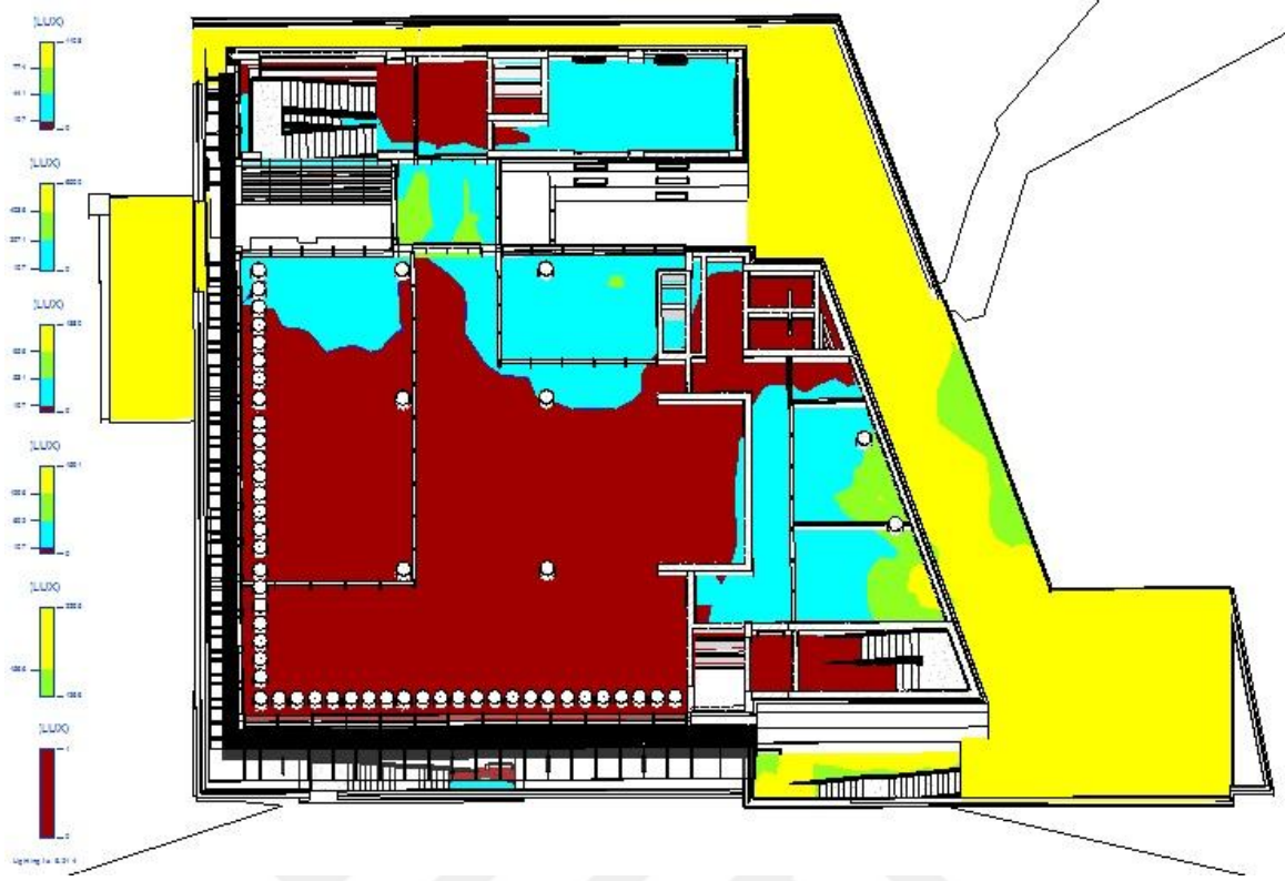
Şekil 5.28. K- Odak Yapısı 1. Senaryo Aydınlatma Analiz Sonuçları
