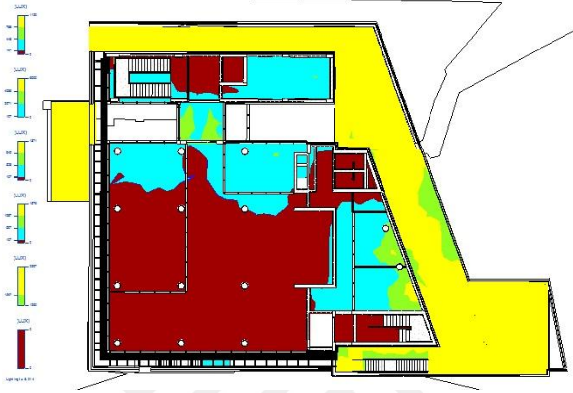
Şekil 5.13. K- Odak Mevcut Yapı Aydınlatma Analiz Sonuçları
