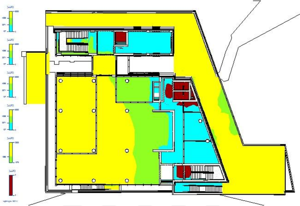
Şekil 5.52. K- Odak Yapısı 3. Senaryo Aydınlatma Analiz Sonuçları
