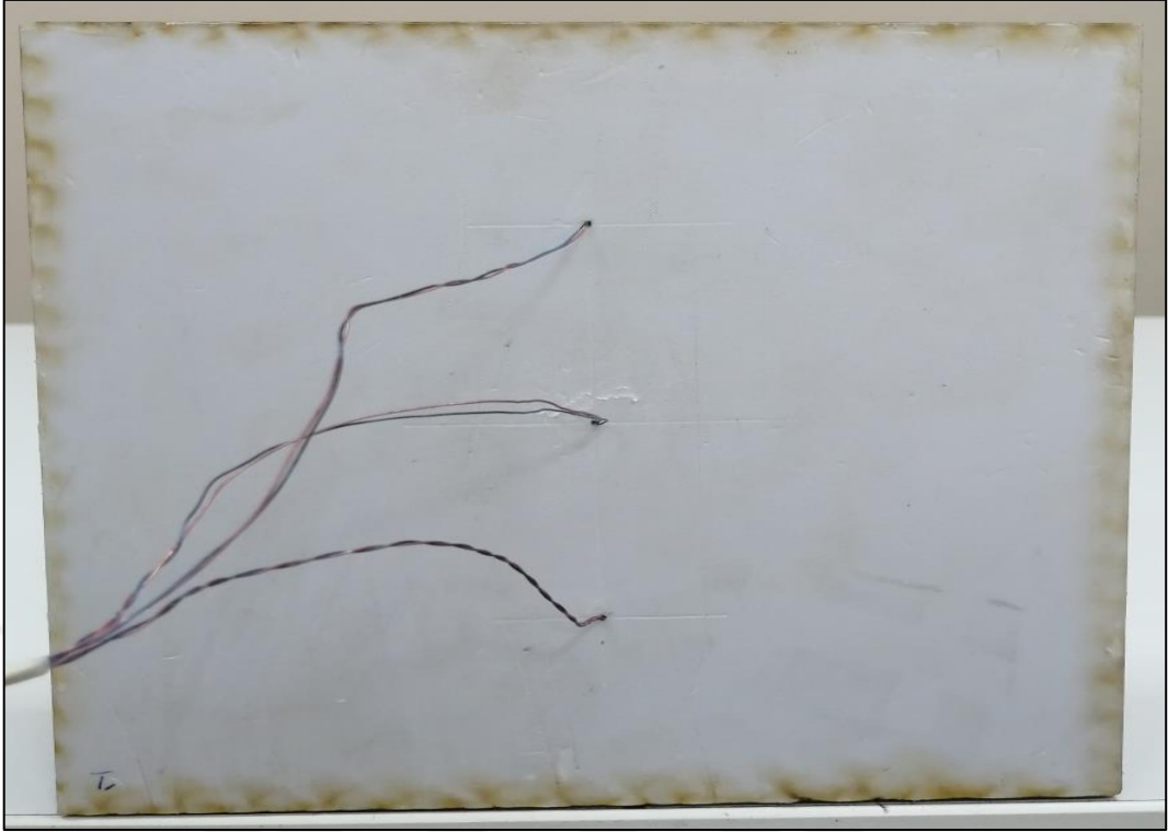
Şekil 24. Deney örneği yüzeyinde termoelemanların bağlantısı
