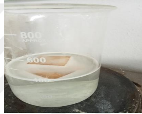
Şekil 3.10. Kaynayan saf su içerisindeki numuneler
