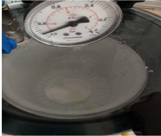
Şekil 9.5. Ahşap içerisine gliserin sızdırılması
