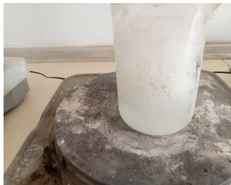
Şekil 6.3. Kaynayan %6lık H_2O_2 çözeltisi içerisindeki numuneler
