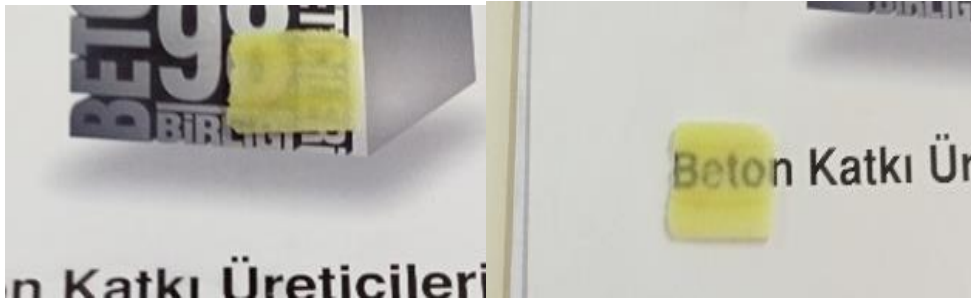
Şekil 12.1. Altıncı deneme çalışması sonucu elde edilen numunenin şeffaflığı
