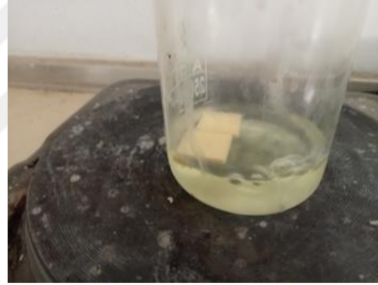
Şekil 8.2. Numunenin %6 lık H_2O_2 çözeltisine konulup ağartılması
