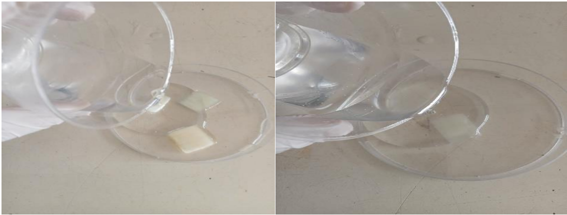
Şekil 6.6. Numunelerin şeffaf epoksi ile kaplanması
