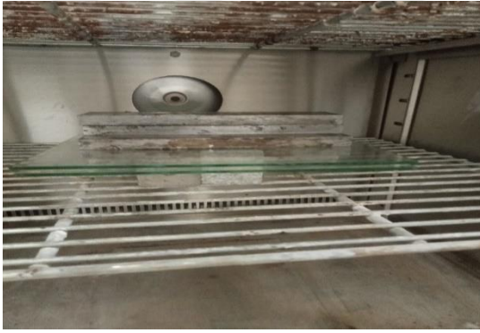
Şekil 3.16. Numunenin etüve konulması
