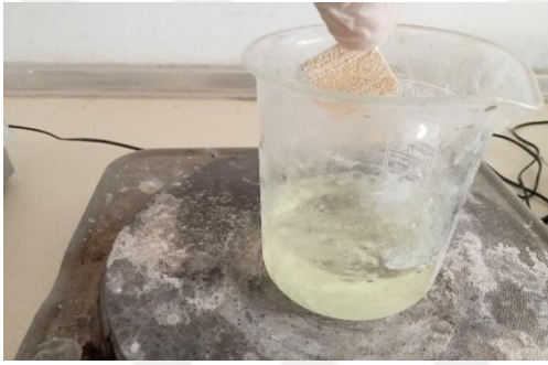
Şekil 7.1. Numunenin çözelti içerisine atılması
