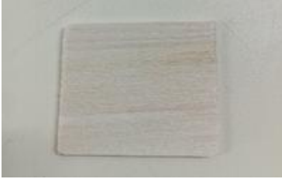
Şekil 4.1. İşlenmemiş kavak ağacı odunundan elde edilmiş numune
