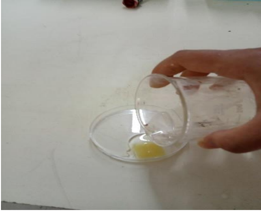
Şekil 8.3. Numunenin üzerine polipropilen 4000 eklenmesi
