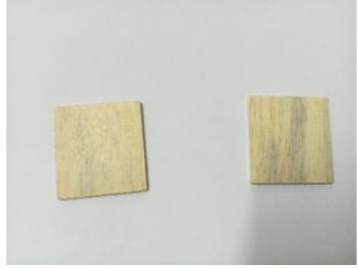
Şekil 3.4. Kayın ağacı odunundan elde edilen numuneler
