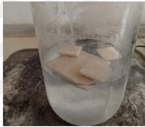
Şekil 6.2. %6lık H_2O_2 çözeltisi içerisindeki numuneler
