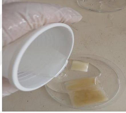
Şekil 5.5. Numunelerin şeffaf epoksi ile kaplanması
