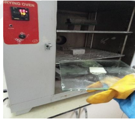
Şekil 4.4. Numunenin 70 °C deki etüve koyulması
