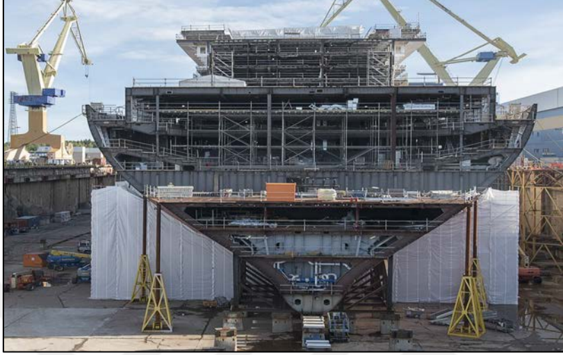
Resim 2.12 Gemi montajı kesit görünümü.
