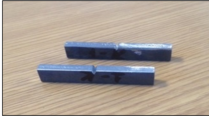
Resim 3.11 Charpy darbe testi numune görünümü.
