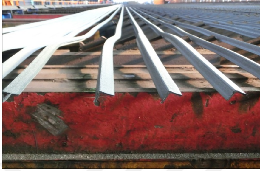
Resim 2.15 Kafaları kırılmış olan 25x25x2.2 mm köşebent profili.
