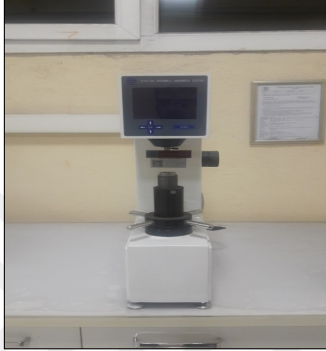
.Resim 3.17 HARDWAY HRS 150 D model sertlik cihazı görünümü
