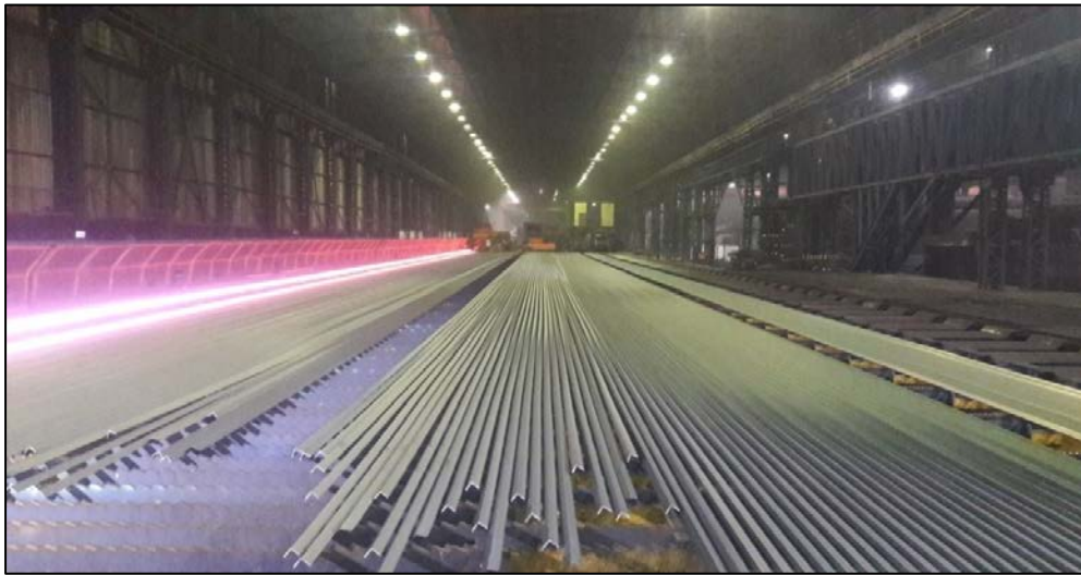
Resim 3.6 50x50x5 mm köşebent üretim akış görüntüsü
