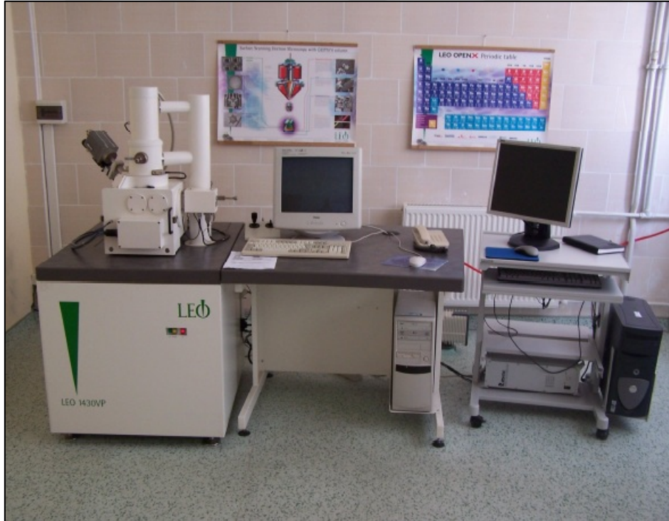
Resim 3.20 LEO 1430VP markalı taramalı elektron mikroskobu (AKÜ TUAM).
