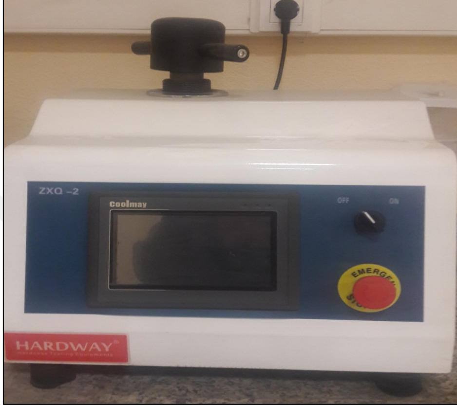
Resim 3.15 HARDWAY ZXQ -2 model bakalite alma cihazı görünümü.
