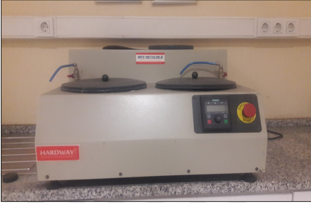
Resim 3.16 HARDWAY MT S2 model zımpara ve parlatma cihazı görünümü.
