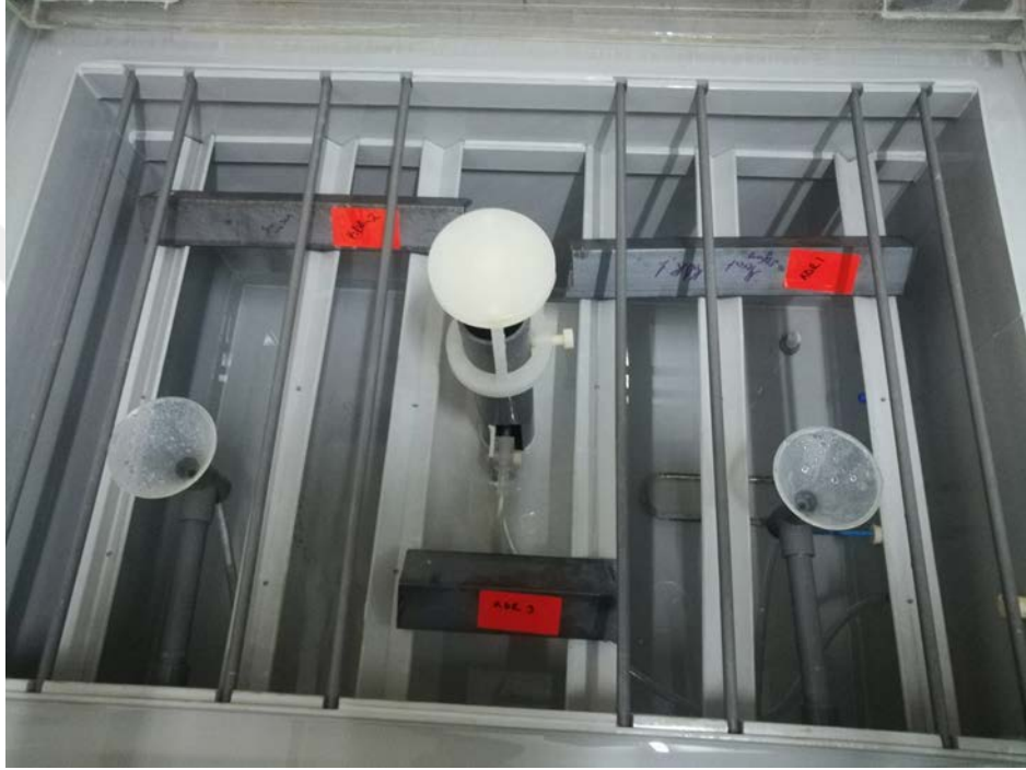
Resim 3.13 Tuz testi numunelerinin yerleşim görünümü.
