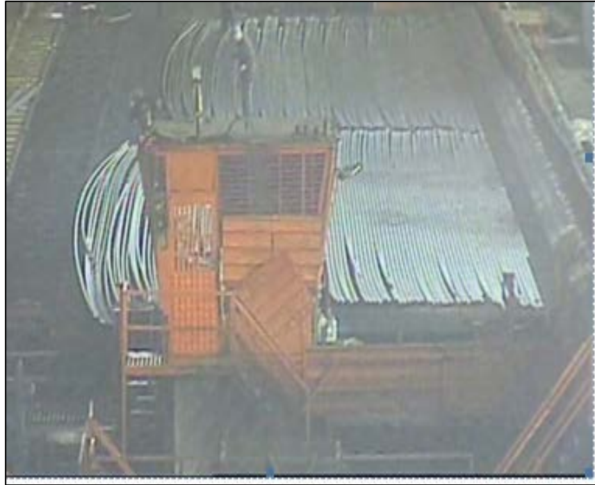
Resim 2.16 Platformda doğrultması bozulan malzemenin kamera görüntüsü.
