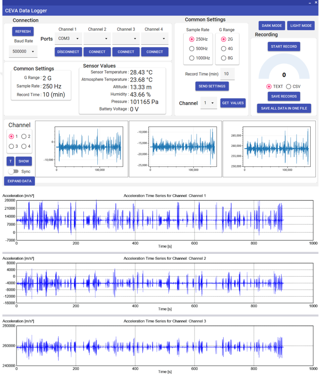
Şekil 71. CEVA Data Logger yazılımı ile ivme verilerine ait görüntü
