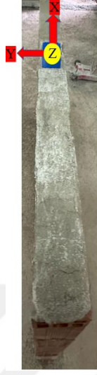
Şekil 58. TDM-3 üzerinde CEVS yerleşim düzeni ve eksenleri
