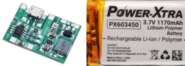
Şekil 18. Şarj modülü ve lityum batarya
