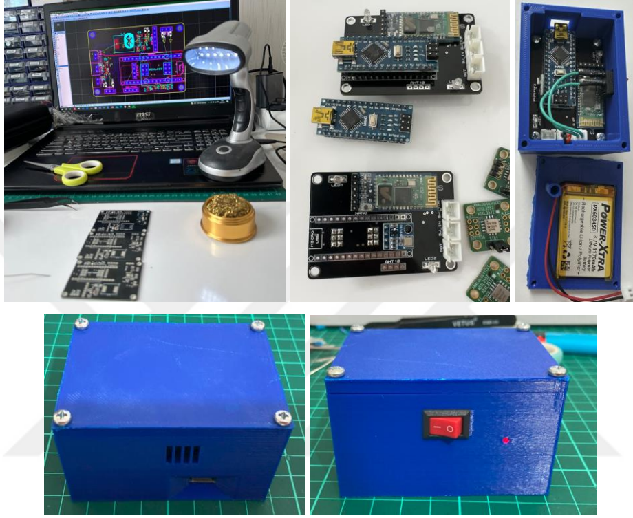
Şekil 24. PCB devre tasarımı ile devre üzerine yerleştirilen sistem elemanları
