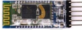
Şekil 16. HC-05 arduino-bluetooth modülü
