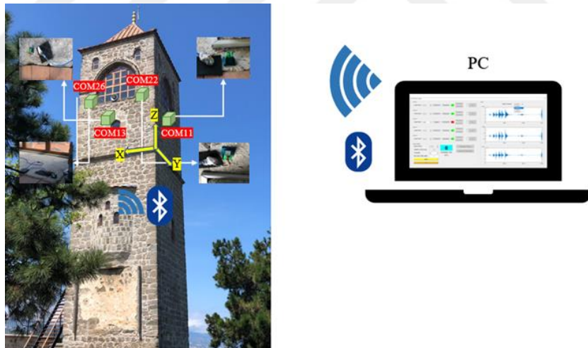
Şekil 13. Sistemin bir yapı üzerindeki veri akış şeması
