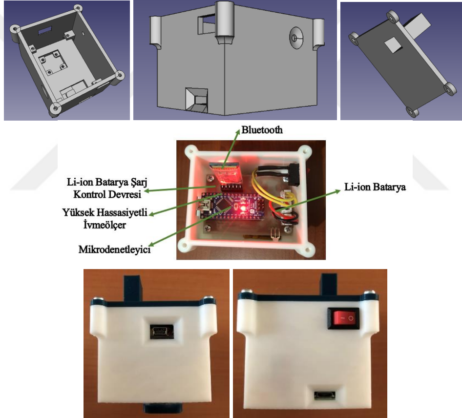
Şekil 23. Kutu tasarımı ve SPI protokolüyle çalışan titreşim ölçüm sistemi
