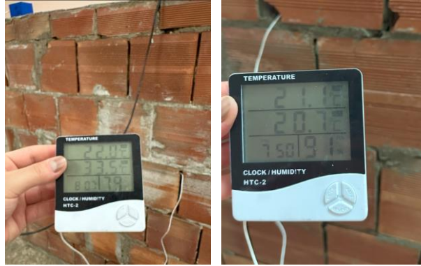
Şekil 59. TDM-3'ün sıcaklık ve nem ölçümü
