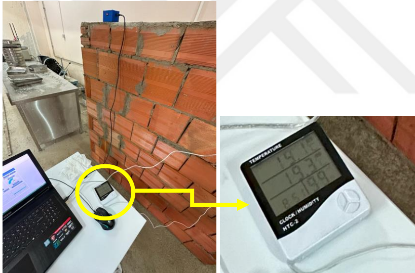
Şekil 51. TDM-1'in sıcaklık ve nem ölçümü
