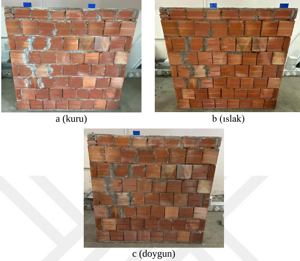
Şekil 48. TDM-1'in kuru, ıslak ve doygun durumları için ÇTT'sine ait görüntü
