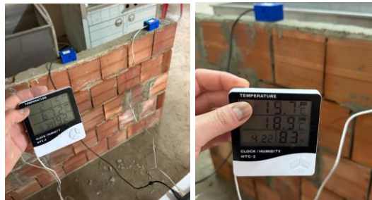
Şekil 55. TDM-2’nin sıcaklık ve nem ölçümü
