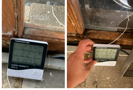
Şekil 72. Kulenin sıcaklık-nem ölçümüne ait bazı görüntüler
