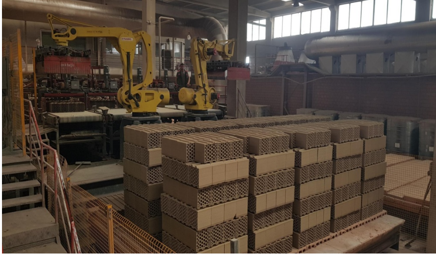
Resim 1.6 İpek Tuğla Fabrikası suni kurutmadan çıkan ürünlerin vagonlara dizilmesi
