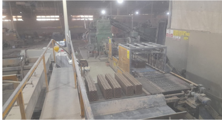
Resim 1.5 İpek Tuğla Fabrikası şekillendirme ünitesi
