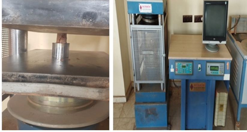
Resim 3.24 Numunelerin basınç mukavemeti test cihazında kırılma anları
