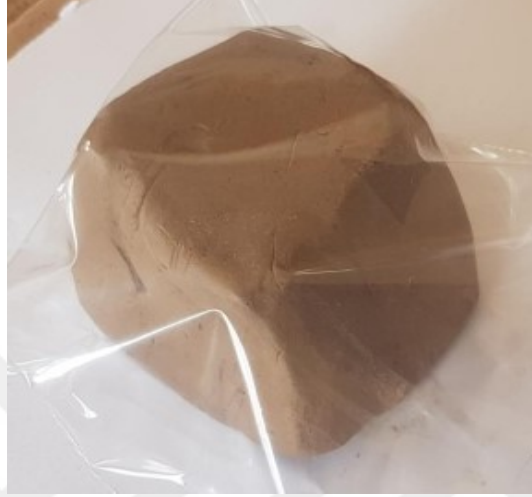
Resim 3.16 Yoğurularak plastik kıvama getirildikten sonra dinlenmeye alınan amur
