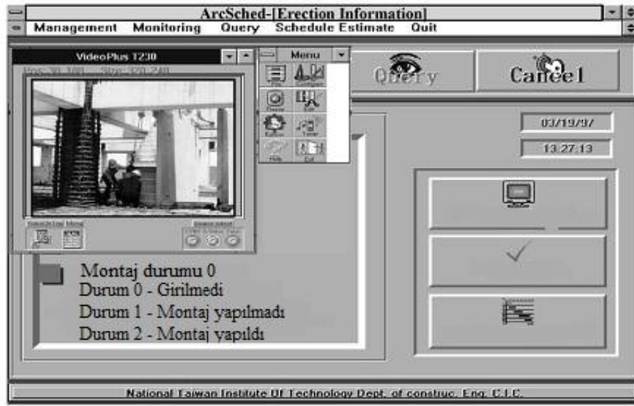
Şekil 2.9 ArcSched gerçek zamanlı montaj görüntüleme menüsü (Cheng ve Chen, 2002)
