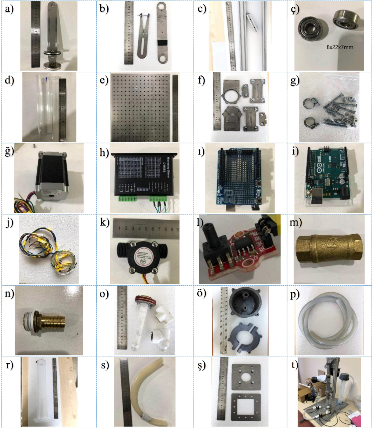
Şekil 3: Parçaların Resimleri, a) Piston, b) Krank ve Biyel, c) Sigma Profiller, ç) Rulmanlar, d) Plastik Tüp, e) Delikli Altık, f) Piston Sabitleme Aparatları, g) Vida ve Kelepçeler, ğ) Adım Motoru, h) Motor Sürücü, ı) Arduino Prototip Kartı, i) Arduino Uno, j) Bağlantı Kabloları, k) Debi Sensörü, l) Basınç Sensörü, m) Çek Valf, n) Hortum Rakoru, o) Plastik Hortum Bağlantıları, ö) 3D Baskı Rezervuar Kapağı, p) Ara Hortumlar, r) Rezervuar, s) Yapay Damar Modeli, ş) Motor Sabitleme Aparatları, ve t) Düzeneğin Genel Görünümü
