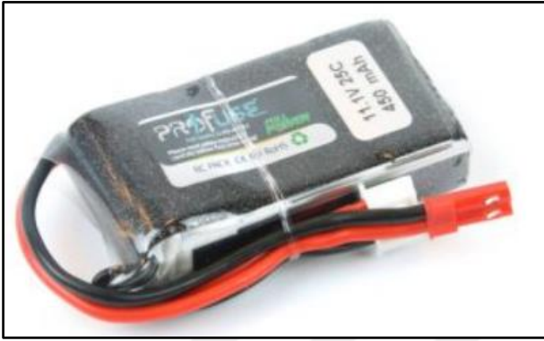
Şekil 3.12. ProFUSE 11.1 V 25 C 450mAh LiPo batarya
