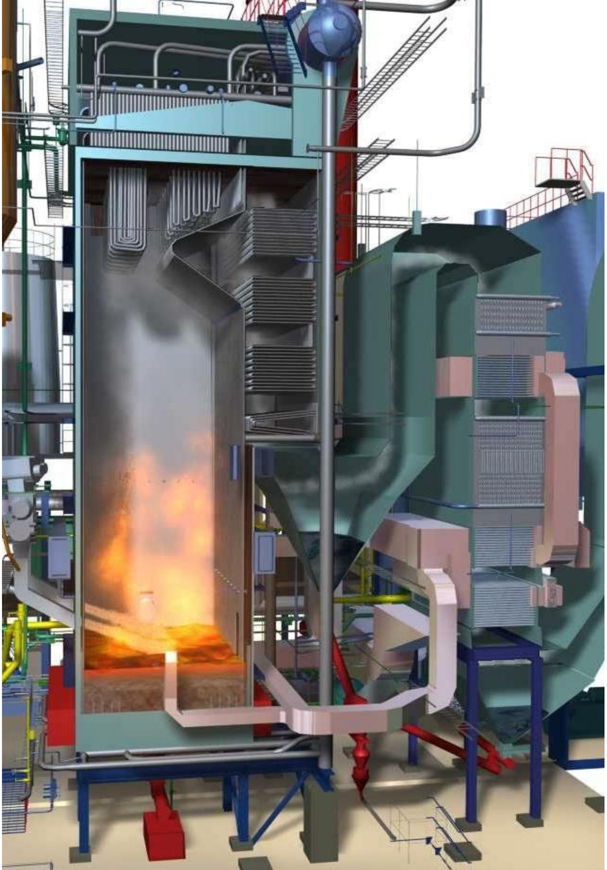
Şekil 2.3 Akışkan yatak kazan kesit görünümü (Teir 2003).
