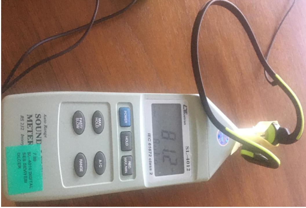
Şekil 4.10 Kemik iletim vibratörü ile ses kalibrasyonu (80 dB).
