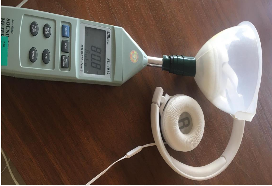
Şekil 4.9 Kulaküstü kulaklık ile ses kalibrasyonu (80 dB).
