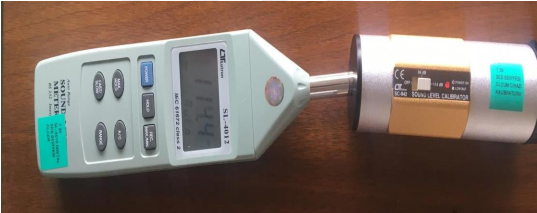
Şekil 4.8 114 dB düzeyi ses kalibrasyonu.
