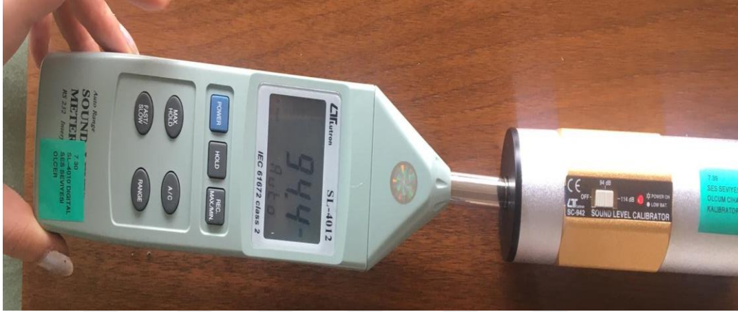
Şekil 4.7 94 dB düzeyi ses kalibrasyonu.
