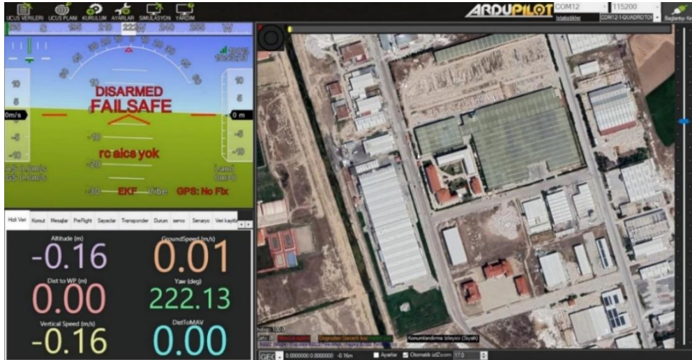
Resim 3.19 FAILSAFE (Arıza) ekranı.
