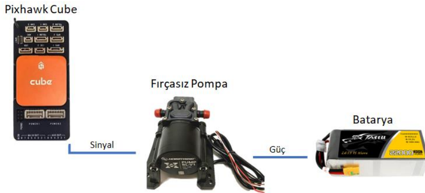
Şekil 3.9 Püskürtme sisteminin otonom ilaçlama yöntemindeki bağlantı şeması.
