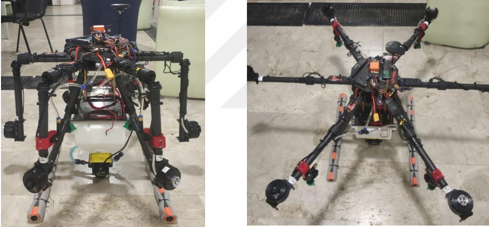
Resim 3.21 Katlanır kol mekanizmasının açık ve kapalı durumu.
