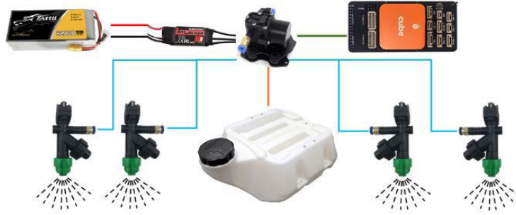
Şekil 3.8 Püskürtme sistemi malzemeleri ve bağlantı yapısı.
