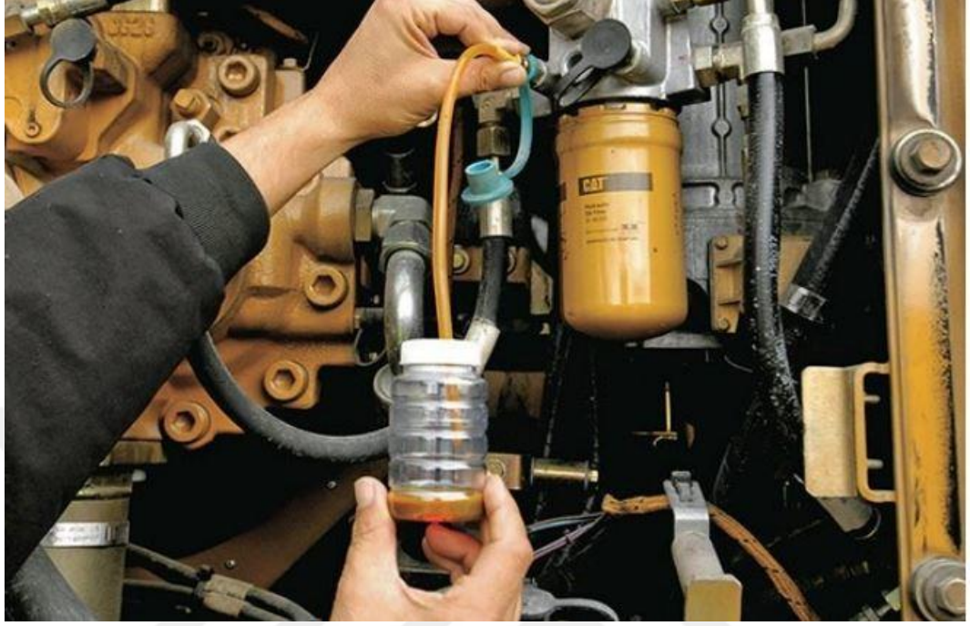
Şekil 3.10. Manuel yağ numunesi alma.
