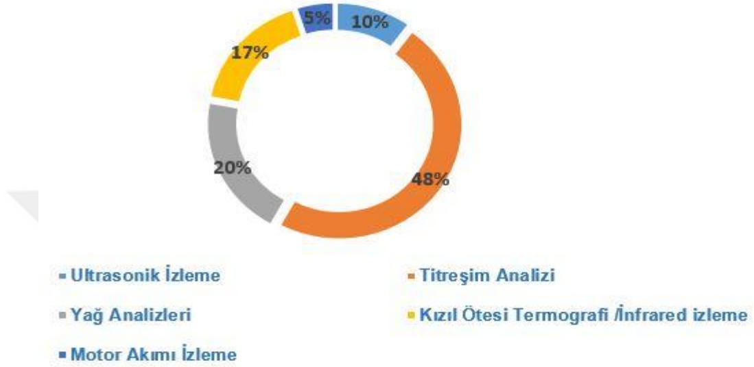
Şekil 3.1. Kestirimci bakım yöntemlerinin uygulama oranları.
