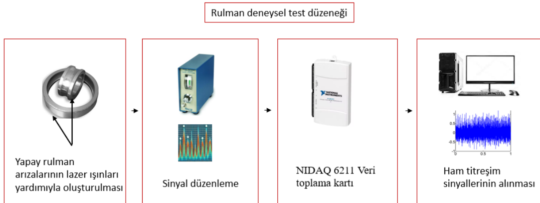
Şekil 3. 1. Titreşim verisi toplama şeması
