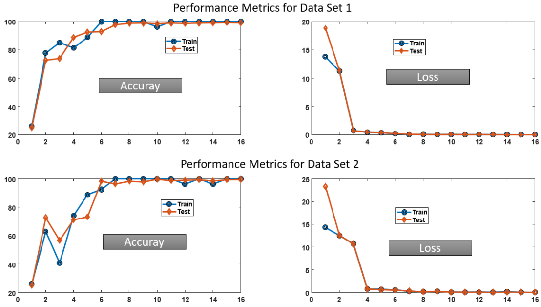
Şekil 4. 3. 1D-CNN+LSTM hibrit modelin performans ve kayıp grafikleri
