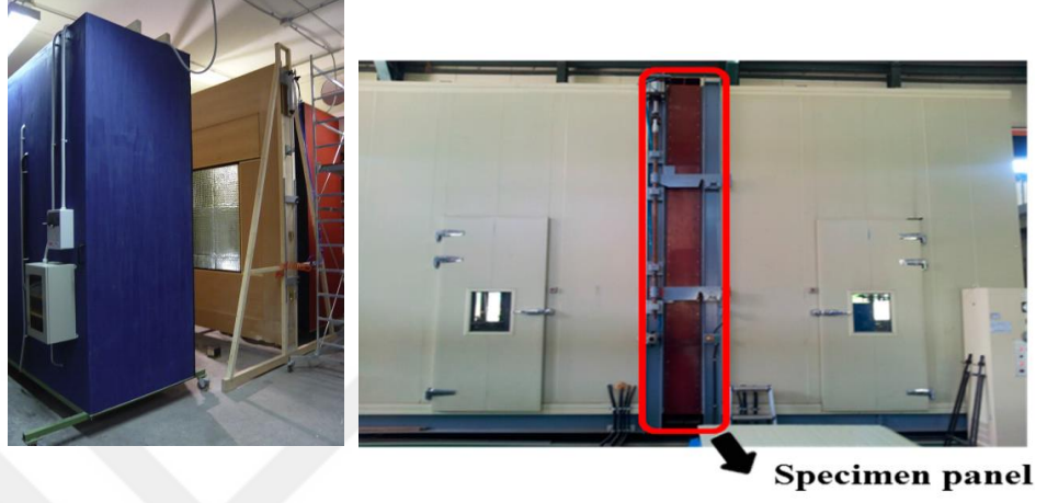
Şekil 2.17. Isıl iletkenlik ölçüm cihazı (Hot box) genel görünüm (Jeong ve ark., 2017)
