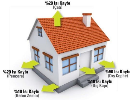
Şekil 2.3. Yapılarda ısı kayıpları (Yaman ve ark., 2015)
