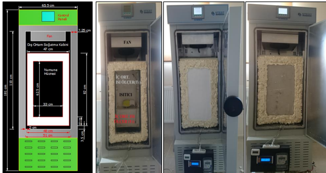
Şekil 4.15. Numunelerin deney düzeneğine yerleştirilmesi.
