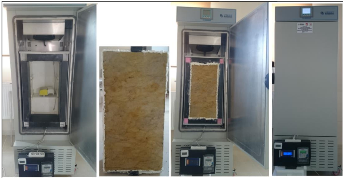
Şekil 4.13. Deney düzeneği aşamalarının taş yünü örneği.
