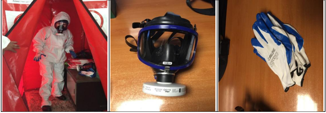
Şekil 5.21 Asbestten koruyucu giysi, maske ve eldiven (Yeşilyurt, 2016)
