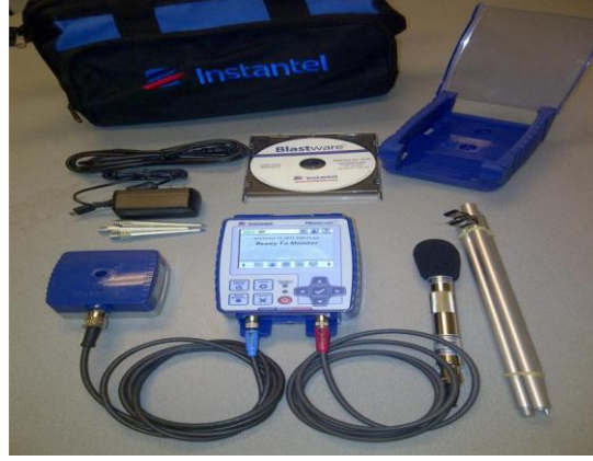
Şekil 5.13 Titreşim ölçüm cihazı (Instantel Micromate Model) (Kazan, 2015)
