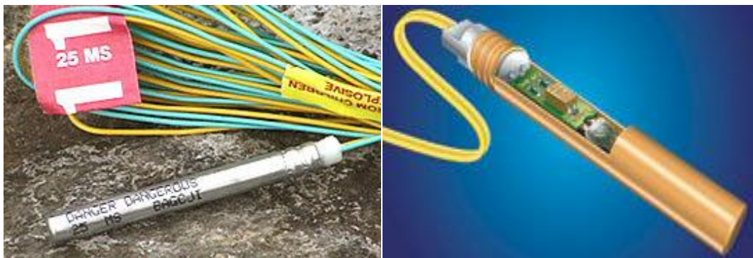
Şekil 5.8 Patlatma ile yıkımlardaki kapsül örnekleri (Koca, 2006)
