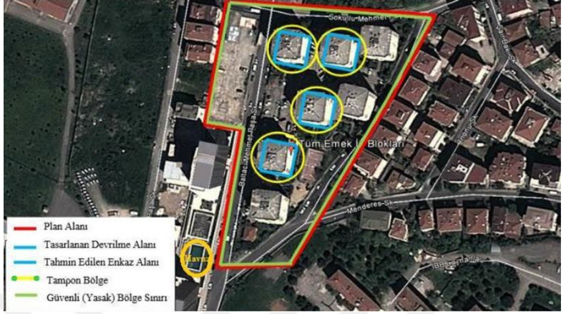
Şekil 5.24 Patlayıcılarla yıkılmadan önce Tüm Emek İş Sitesi için çizilen dört sınır çizgisi (Özer ve diğer., 2015)
