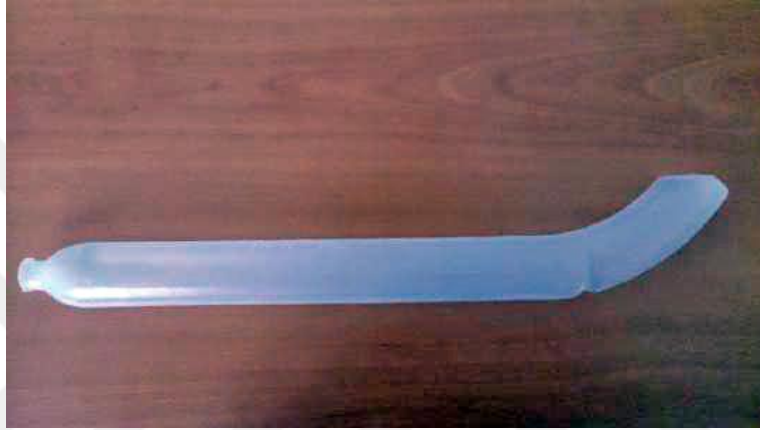
Şekil 5.2 Patlatma esnasında deliklere yerleştirilen sulu sıkılama kartuşu (Özdoğan ve diğer., 2015)
