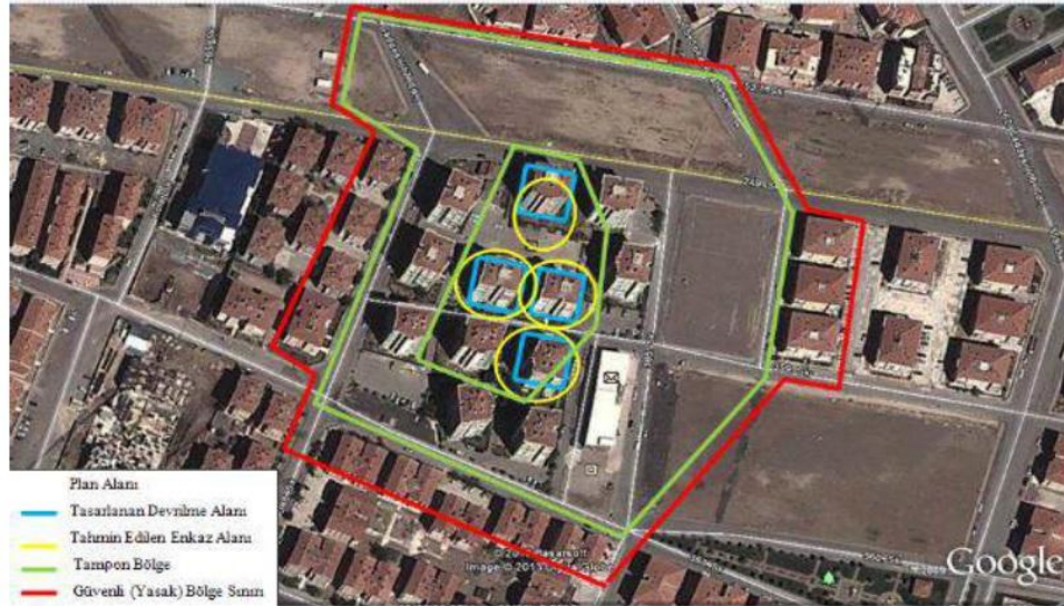
Şekil 5.10 Güneşevler Sitesi patlatma ile yıkımında oluşturulan güvenlik bölgesi üst görünümü (Karadoğan ve diğer., 2015)
