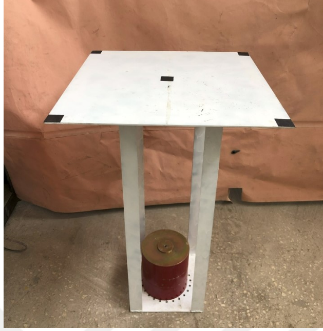
Şekil 8. Tek katlı uzay kayma çerçevesi modeli
