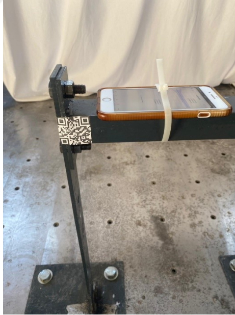
Şekil 5. iDynamics Uygulaması yüklü mobil telefonun kirişe bağlanması
