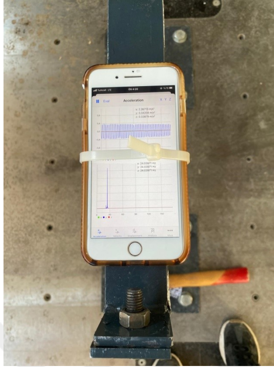
Şekil 6. Modele uygulanan titreşimin iDynamics Uygulaması'nda görülen ivme kaydı
