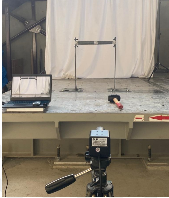
Şekil 3. Tek katlı düzlem çelik çerçeve modelinin video çekim düzeneği
