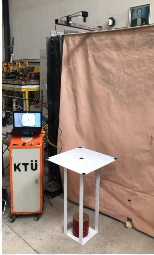
Şekil 11. Tek katlı uzay kayma çerçevesi modelinin video çekim düzeneği
