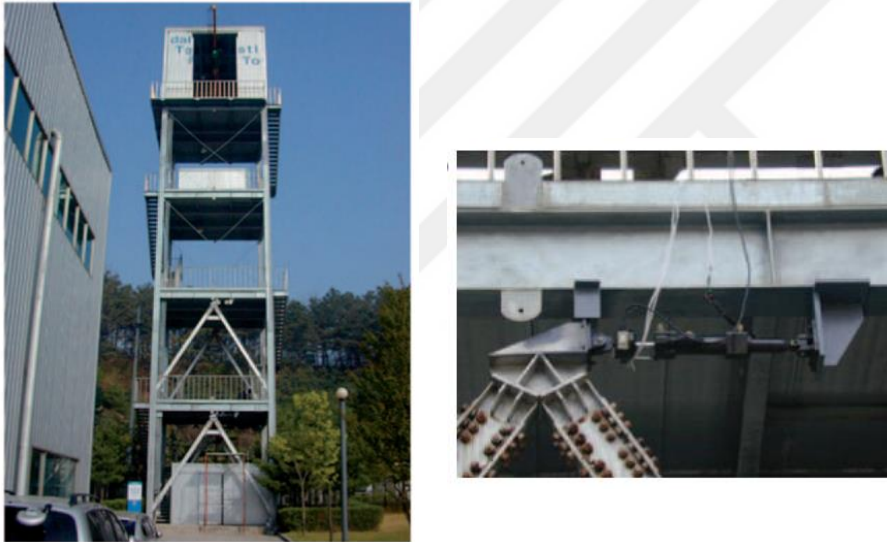
Şekil 2.22. Tam ölçekli yapısal sistem ve MR damper detayı (Lee ve ark, 2010).
