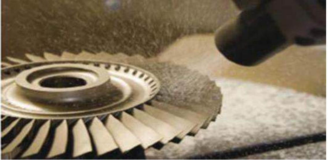
Şekil 2.2 – Bilya püskürtme yöntemi
