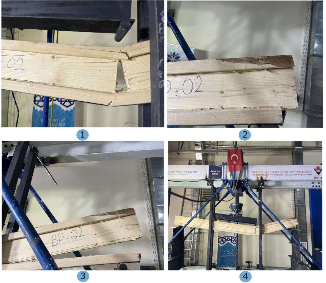
Şekil 5.3. BP02 numunesi için yük-deplasman eğrisi ve hasar mekanizmaları
