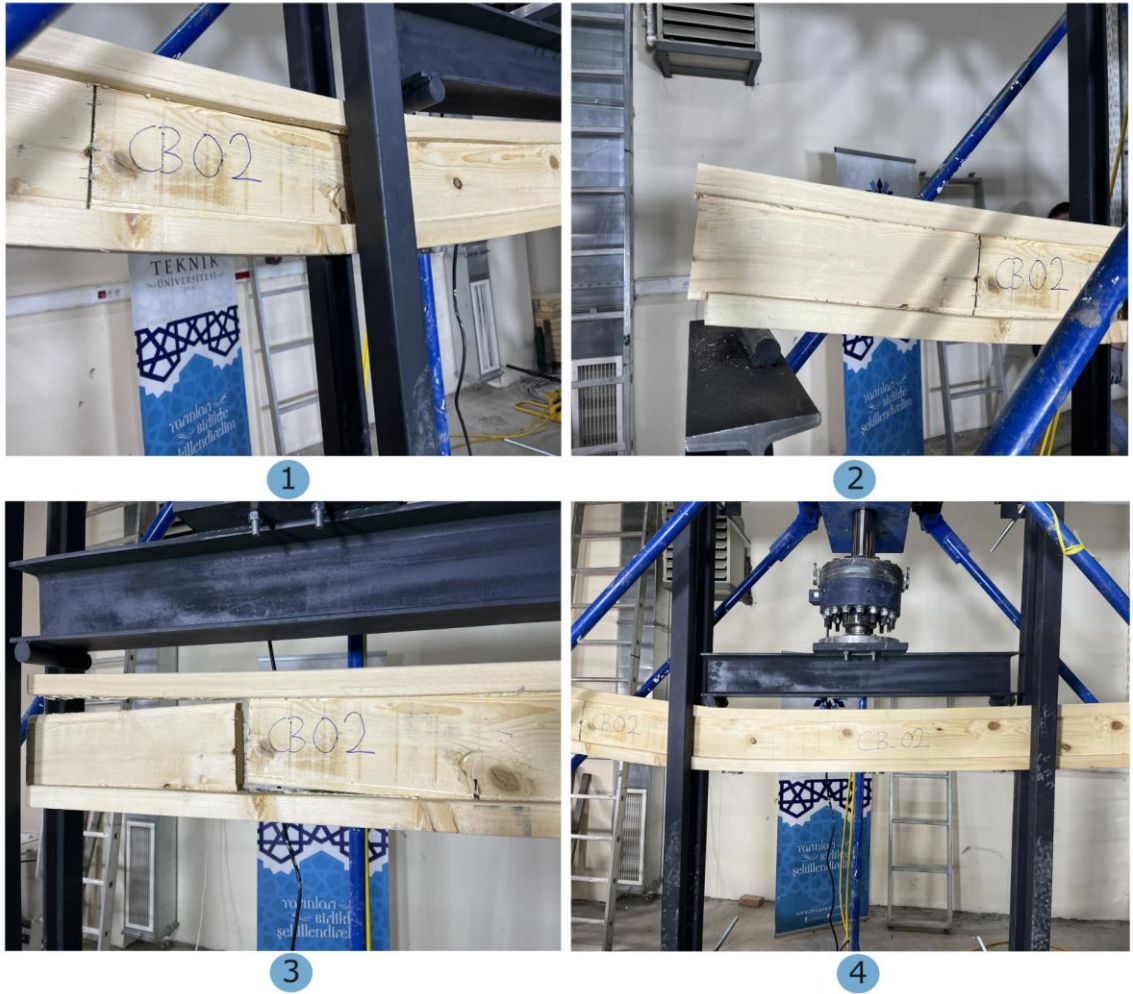
Şekil 5.1. CB02 kontrol numunesi için yük-deplasman eğrisi ve hasar mekanizmaları (CB kontrol numunelerinin tamamı için bkz. Ek-1A)
