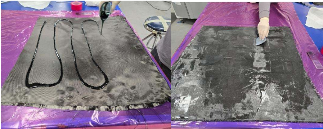
Görsel 6.6. Kuru kumaşın reçine ile ıslatılması ve spatula yardımıyla emdirilmesi
