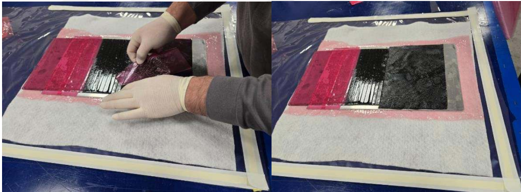
Görsel 6.8. Islatılmış olan kumaşların serim planına göre uygun şekilde yerleştirilmesi
