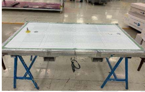
Görsel 6.3. Vakum paketine alınmış otoklav a girmeye hazır plaka deney plakaları görseli
