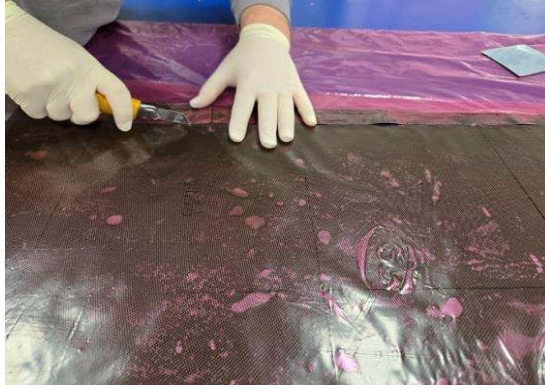
Görsel 6.7. Reçine emdirilmiş kumaşların şablona uygun şekilde kesilmesi
