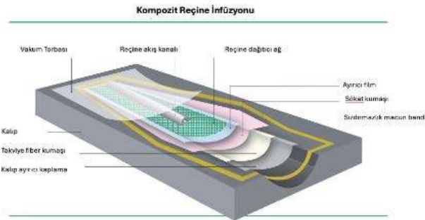
Şekil 2.10. Vakum infüzyon metodu için gerekli serim planı(EXPO-NET Resin Flow Mesh Products, 2021)
