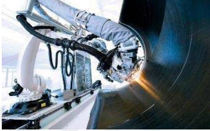
Görsel 2.1. Otomatik fiber serim metoduna ait bir görsel(Automated Fiber Placement - Cailabs, 2025)
