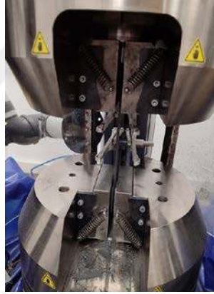
Görsel 6.10. Test cihazına bağlanmış test kuponu görseli
