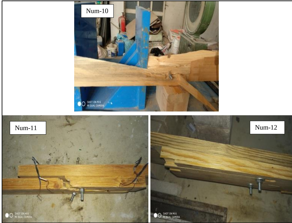
Resim 4.4. Numune 10,11 ve 12'nin göçme mekanizmaları
