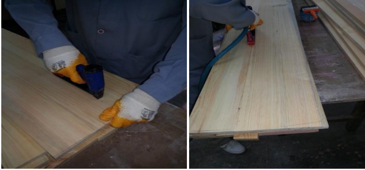
Resim 3.2. Lamellerin düz en birleştirme yapılan bölgelerine U çivi çakılması
