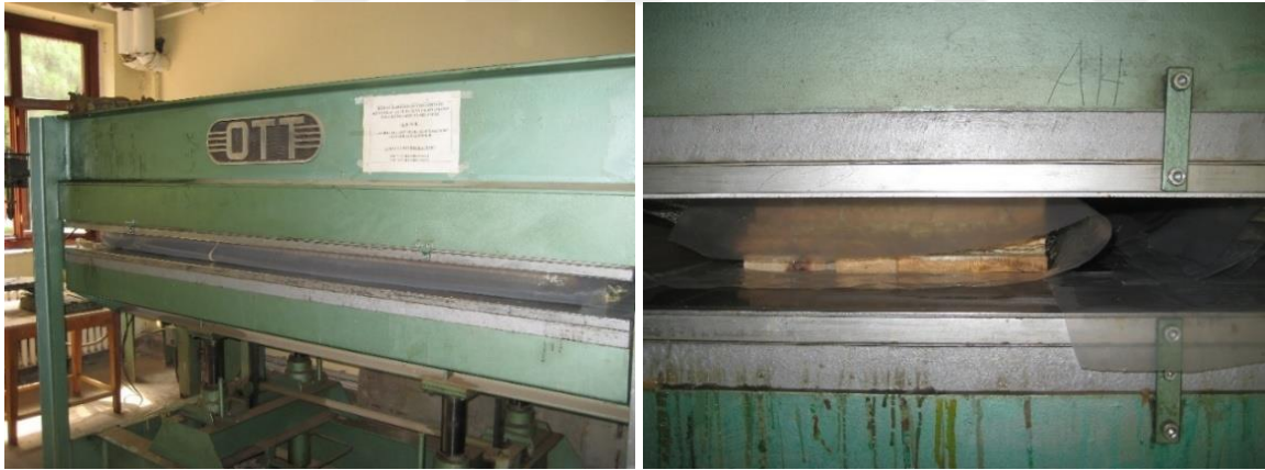
Resim 3.3. Lamine ahşap yapı elemanlarının preslenmesi
