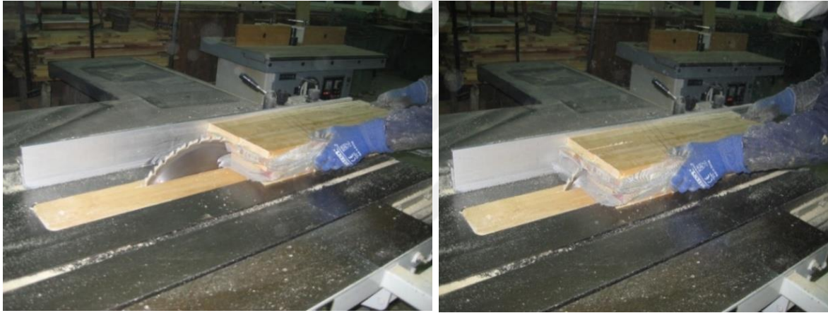
Resim 3.5. Liflere paralel basınç mukavemeti tayini için kullanılacak numunelerin daire testerede en ölçülendirilmesi
