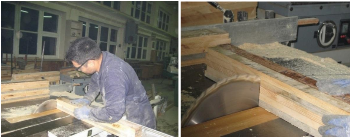
Resim 3.6. Eğilme mukavemeti ve liflere paralel basınç mukavemeti tayini için kullanılacak numunelerin daire testerede boy ölçülendirilmesi
