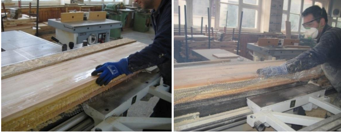
Resim 3.4. Eğilme mukavemeti tayini için kullanılacak numunelerin daire testerede en ölçülendirilmesi
