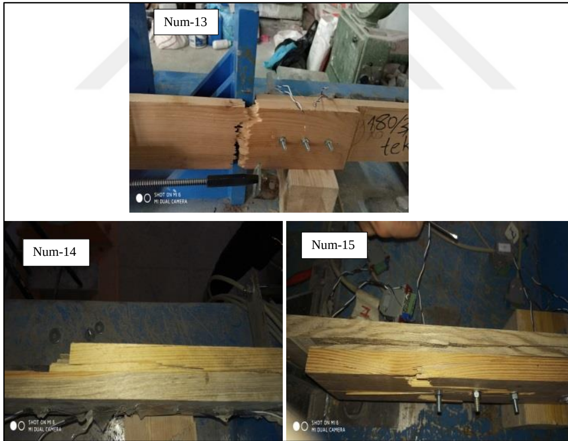
Resim 4.5. Numune 13,14 ve 15'in göçme mekanizmaları
