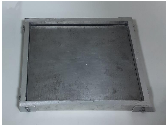
Şekil 3.4. Yapıştırıcıyla birleştirilmiş bağlantılarda kullanılan özel tasarlanmış kalıp
