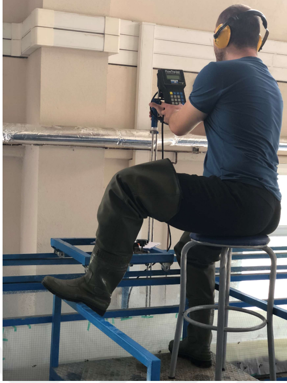
Ek 5. Bartın Üniversitesi hidro-mekanik labaratuvarı Akustik dopler velocity yardımıyla ölçümlerin alınması
