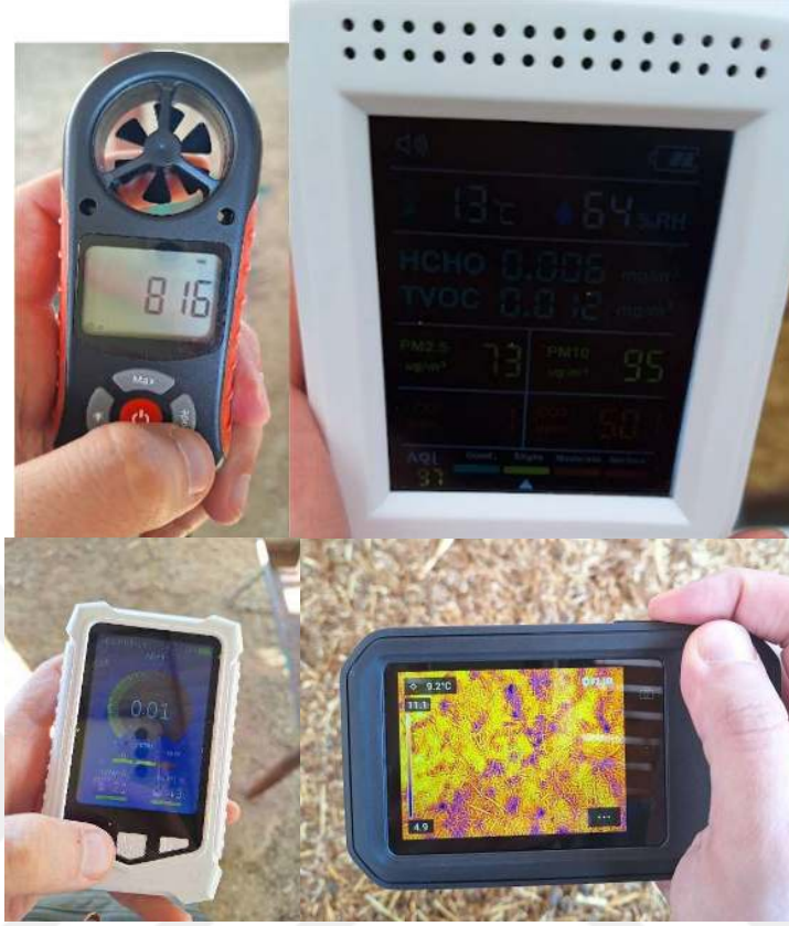
Şekil 3.12. (A) Rüzgâr hızı, rakım ve hava basıncı verilerini ölçen anemometre, (B) sıcaklık, nem, HCHO, tUOB, PM2.5, PM10, CO ve CO 2 değerlerini ölçen hava kalite ölçüm cihazı, (C) sıcaklık, nem ve NH 3 değerlerini ölçen cihaz ve (D) zemin sıcaklığı ölçümü için kullanılan termal kamera.
