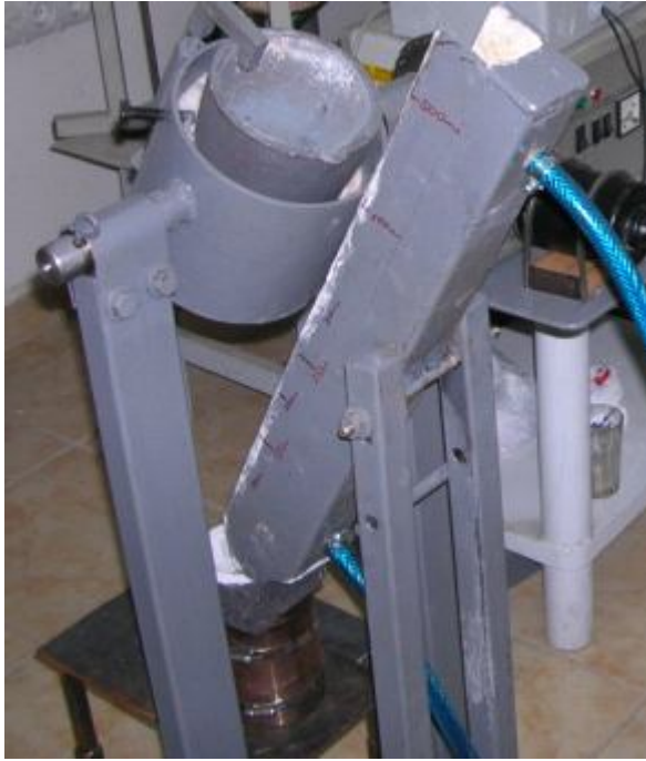
Resim 5.1. Eğimli Soğutma Plakasına Döküm Ünitesi (ESP)
