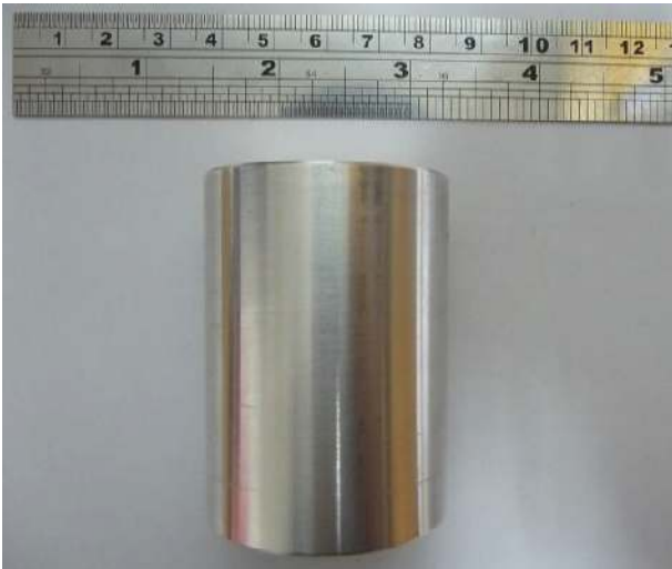
Resim 5.4. Soğuk deformasyon sonrası tornalanarak işlenmiş tikso-dökümle şekillendirmeye hazır numune
