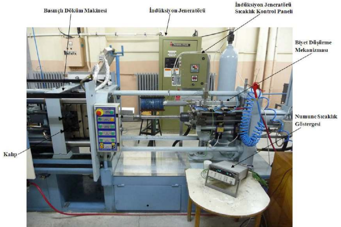
Resim 5.5. Yarı-katı metal şekillendirme ünitesinin genel görünümü
