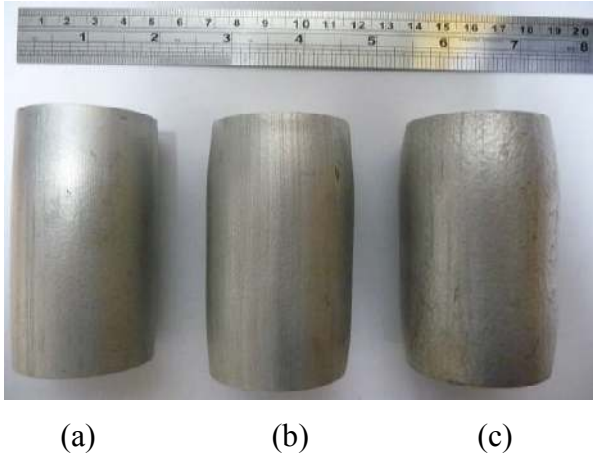
Resim 5.2. Soğuk deformasyon sonrası 75 mm boy uzunluğuna getirilen numunelerin soğuk deformasyon oranları; a) %10, b) %20 ve c) %30
