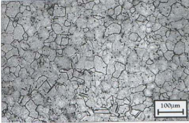
Resim 3.4. Osprey işlemi ile üretilmiş IN718 alaşımasının ince taneli yapısı [20]
