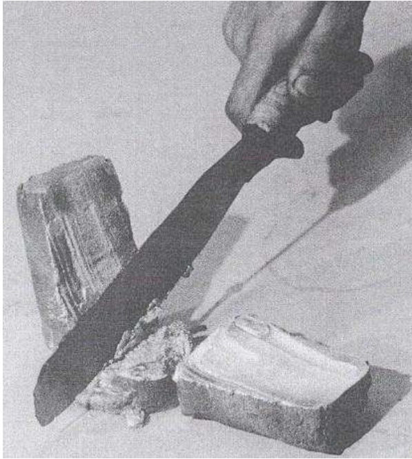
Resim 2.4. Yarı katı durumdaki bir Al alaşımlarının bıçak ile kesilmesi [Flemings 1991, Kenney ve ark., 1988]
