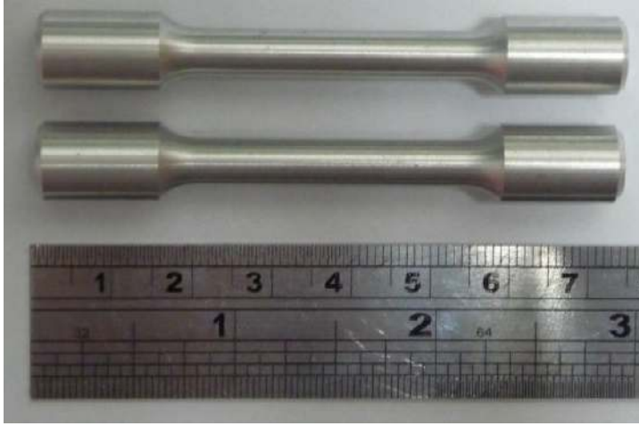
Resim 5.13. Tikso-dökümle şekillendirme sonrası işlenmiş haldeki çekme numuneleri
