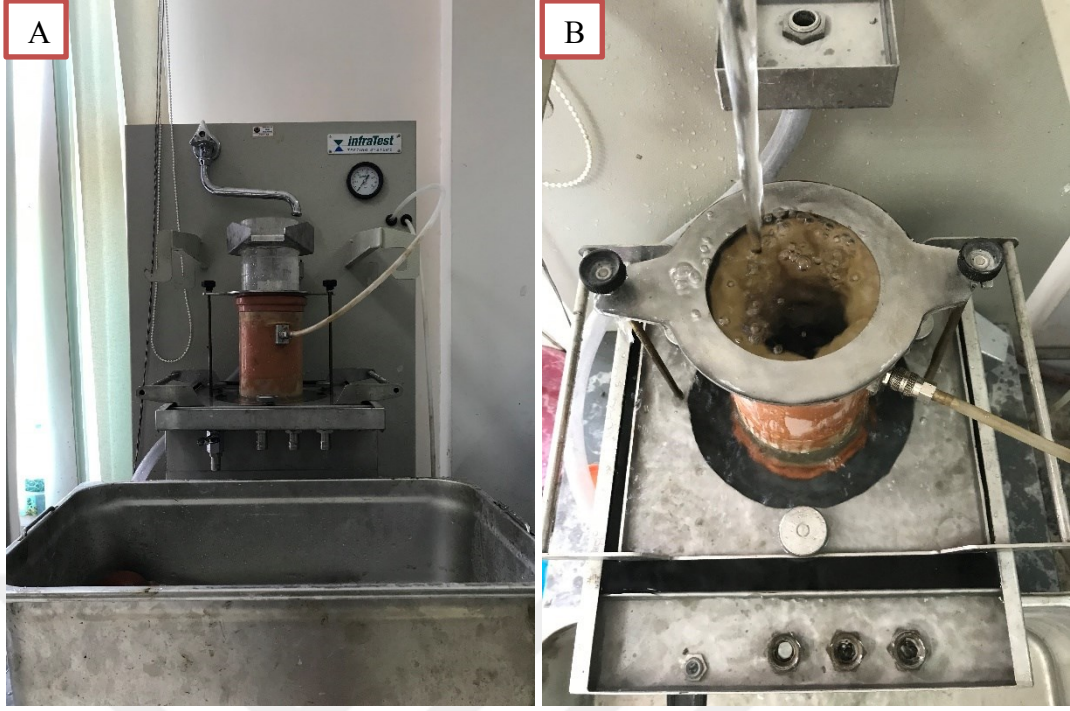
Şekil 3.23. Permeabilite deneyi; a) Permeabilite deneyi cihazı; b) Numunenin yerleştirildiği boru
