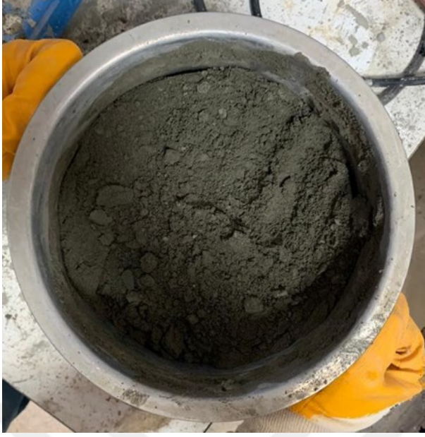
Şekil 3.10. %25 su/ç oranına ve %1 SA miktarına sahip harç
