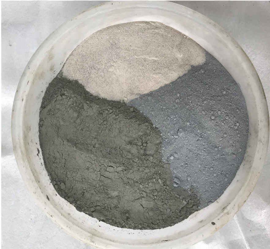
Şekil 3.12. Silis dumanı içeren kuru harç
