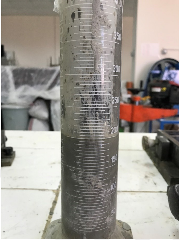
Şekil 3.6. Terleme deneyi için harç yerleştirilmiş beher
