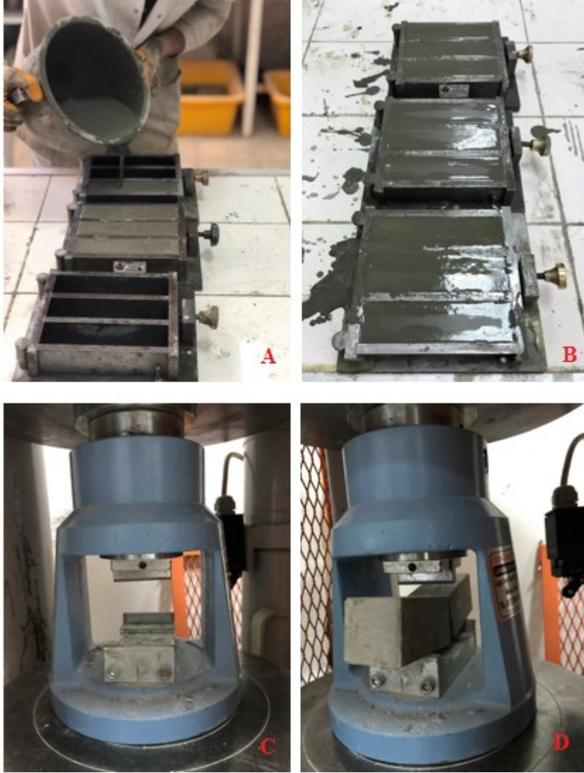
Şekil 3.8. Eğilme dayanımı deney aşamaları; a) Harcın deney kalıplarına yerleştirilmesi; b) Deney için hazırlanmış kalıplar; c) Deney cihazına yerleştirilmiş eğilme dayanımı deney başlığı; d) Eğilme dayanımı deneyine tabi tutulmuş numune
