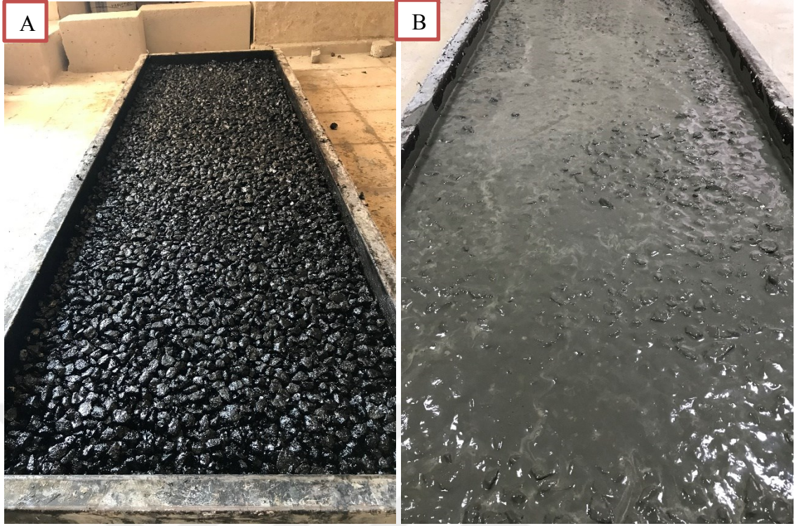
Şekil 3.15. YRK'nin oluşturulması; a) Boşluklu asfalt b) Harç yerleştirilmiş boşluklu asfalt
