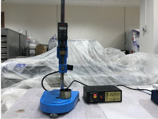
Şekil 3.1. Penetrasyon deneyi düzeneği
