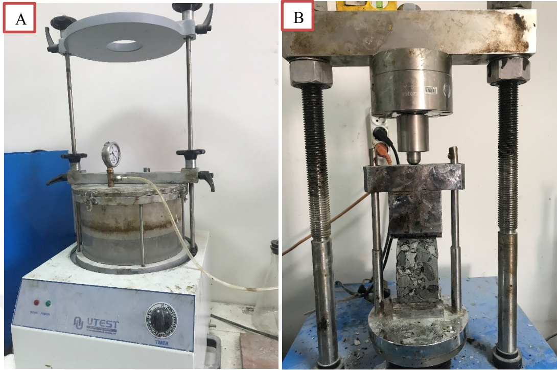
Şekil 3.19. Nem hasarına karşı direnç deneyi; a) Desikatör; b) Numunenin aksenal olarak kırılması
