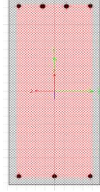
Şekil 4.17 : 30x70 boyutlarındaki kiriş kesiti ve donatısı.
