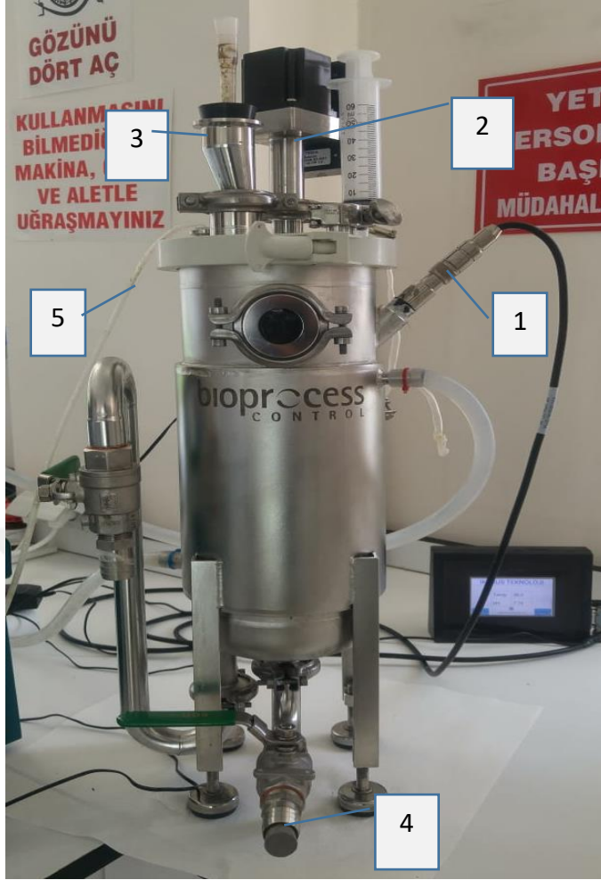
Şekil 3.6 Yarı-sürekli beslemeli tam karışimli anaerobik reaktör sistemi; 1: pH ve sıcaklık sensörleri (Online), 2: Mekanik karıştırıcı, 3: Reaktör besleme girişi, 4: Reaktör numune çıkışı, 5: Reaktör gaz çıkışı hortumu
