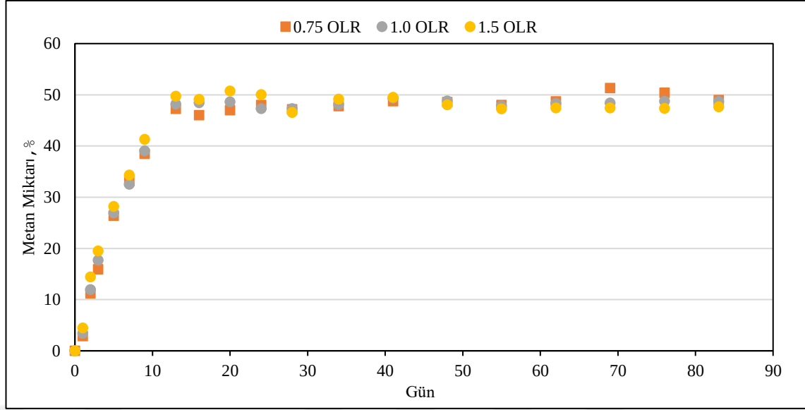
Şekil 4.2. Farklı organik madde yükleme hızlarında (OLR) üretilen biyogaz içerisindeki metan (%) zamanla değişimi
