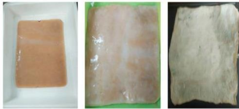
Őekil 1.7 : Hasat edilmiŐ ve NaOH ile yıkanarak kurutulmuŐ Kombua selloz
