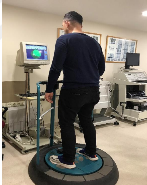
Şekil 3.6. Dengenin Sport KAT-3000 Cihazı ile Değerlendirmesi
