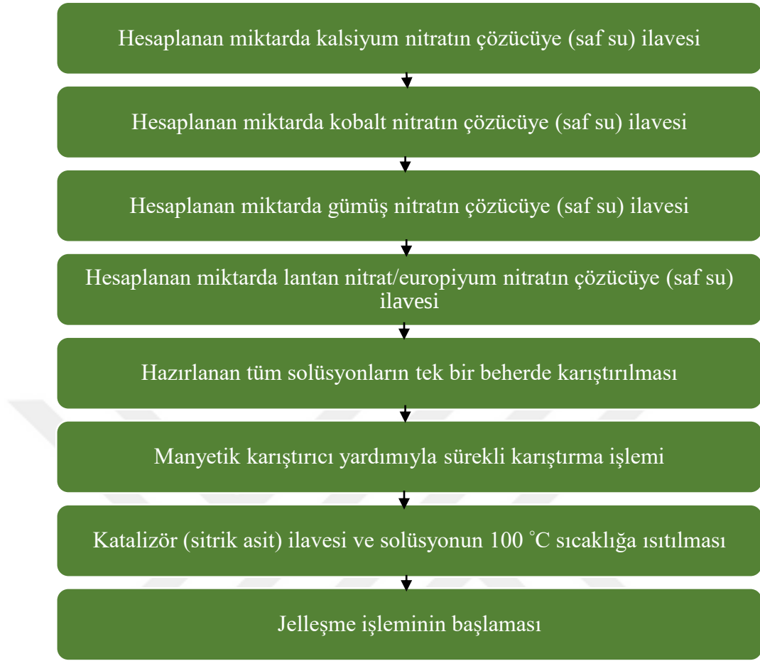
Şekil 3.1 P- tipi yarı iletken malzemenin solüsyon hazırlama akış şeması
