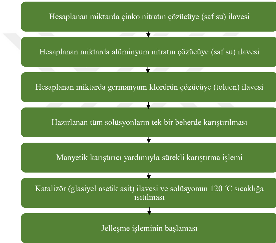
Şekil 3.2 N- tipi yarı iletken malzeme için solüsyon hazırlama işleminin akış şeması
