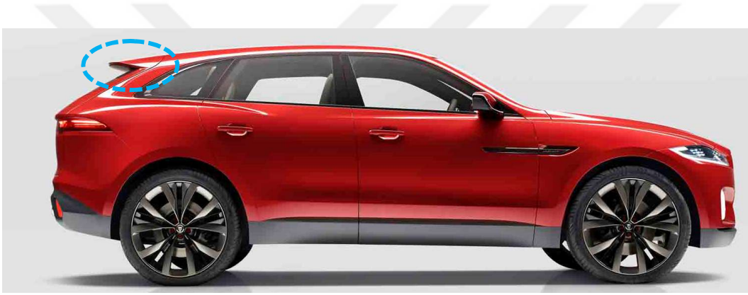
Resim 1.2. Araca etkiyen direnç kuvvetini düşürmeye yarayan arka üst spoyler (URL-2, 2014)
