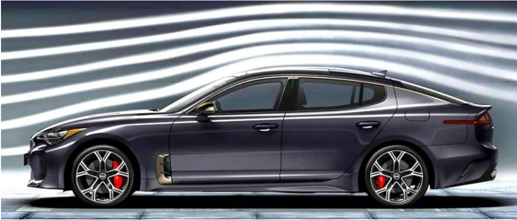
Resim 1.1. Düşük direnç kuvvetine sahip yarım su damlası şekline benzetilen araba üst kısmının yandan görünümü (URL-1, 2021)
