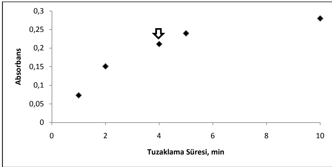
Şekil 4.19. YKT-AT-AAAS'de 1.0 M HNO 3 'de 200 ng/mL Sb çözeltisi kullanarak tuzaklama süresinin optimizasyonu
