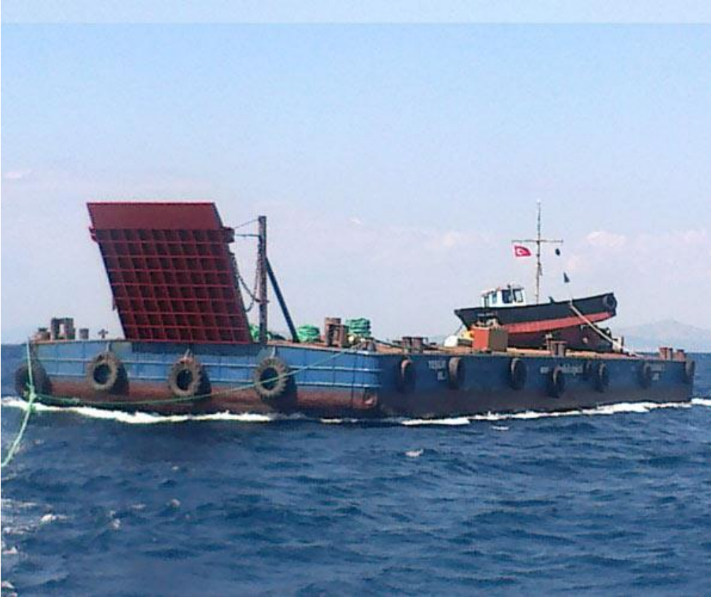
Şekil 4.40 Yapay resif bloklarının naklinde ve yerleştirilmesinde kullanılacak duba
