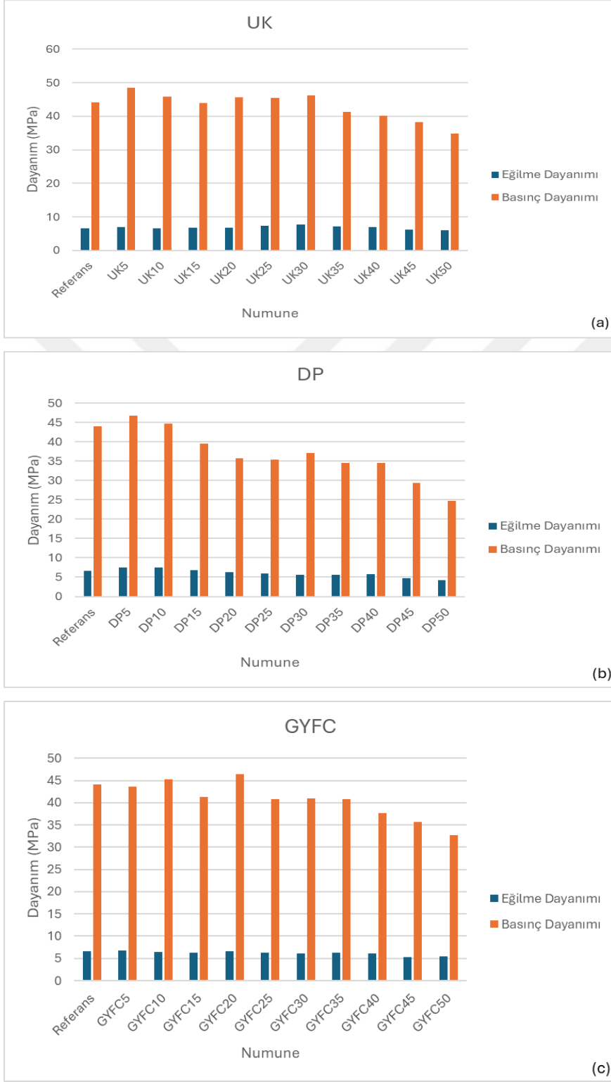
Şekil 4.1. Numunelerin basınç ve eğilme dayanımı sonuçları ((a) Uçucu kül, (b) Doğal puzolan, (c) Granüle yüksek fırın cürufu)
