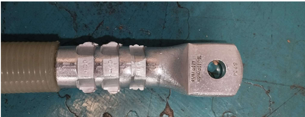
Şekil 4.24. Pabuç takılmış kablo numunesi
