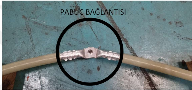
Şekil 4.5. Test numunesinin pabuç bağlantısı
