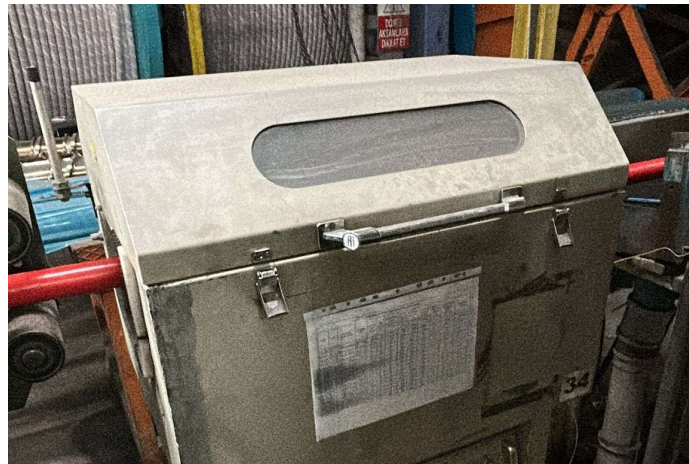
Şekil 4.19. Kılıf kıvılcım deneyi
