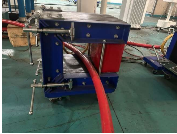
Şekil 4.4. İndüksiyon bobini içerisinde geçirilen kablo numunesi
