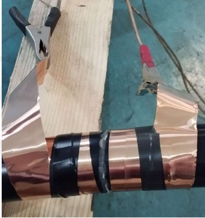
Şekil 4.25. Tanδ deneyi için numunenin bağlantısı
