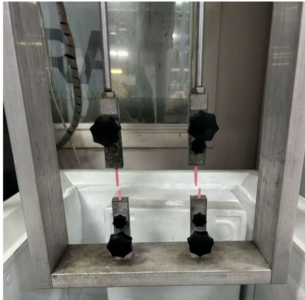
Şekil 4.15. Soğukta uzama deneyi
