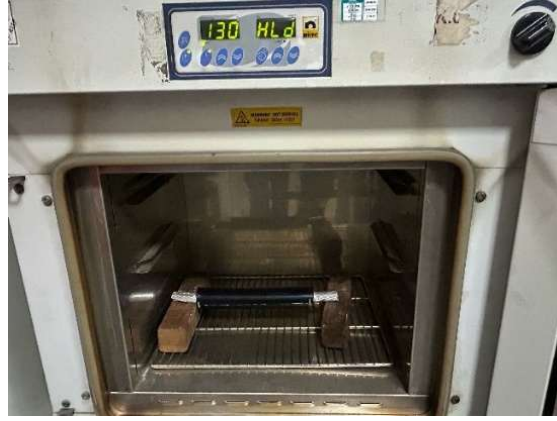
Şekil 4.11. Büzülme deneyi için etüve yerleştirilen numune
