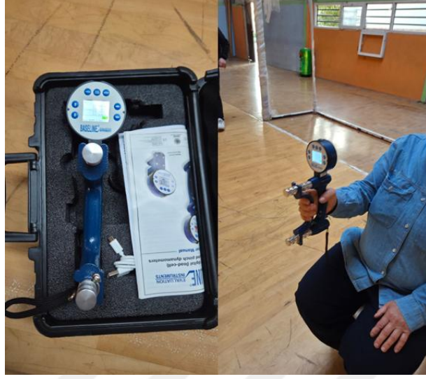
Şekil 3.6. JAMAR El Dinamometresi ile kavrama kuvvetinin ölçülmesi
